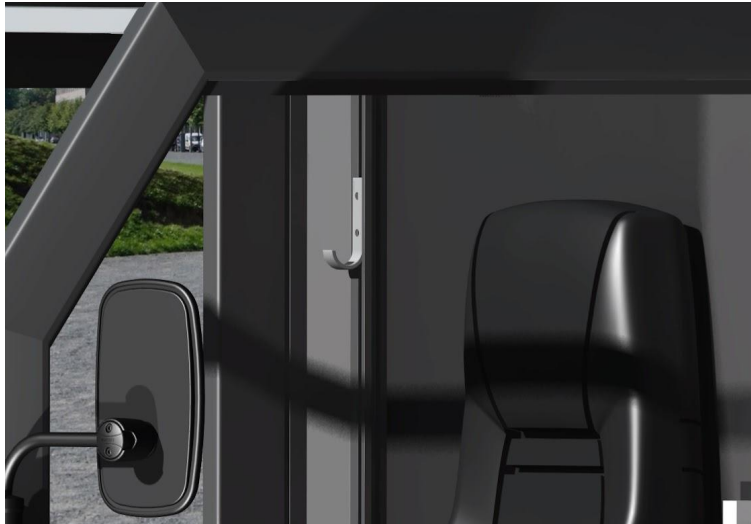
Figur 48: Rendering i Catia som visar kroken i förarhytten.
