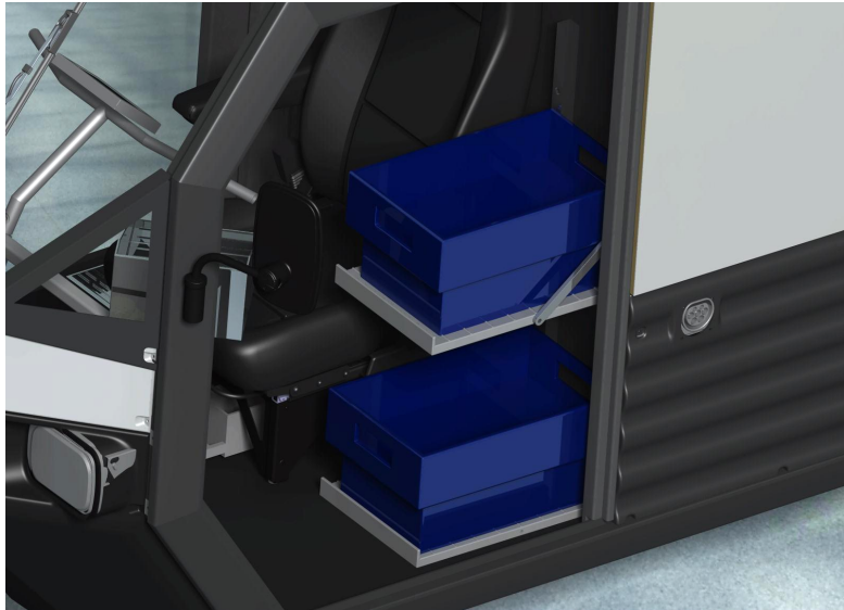
Figur 43: Rendering i CAD programmet Catia V5 som visar hyllan med två standardlådor sett från utsidan.
