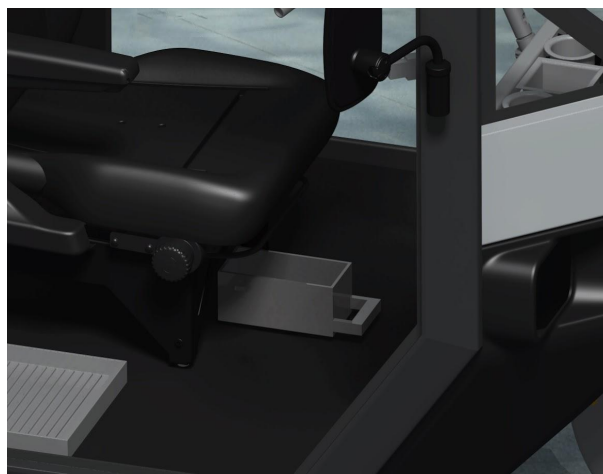
Figur 51: Rendering i Catia V5 som illustrerar utdragen personlig förvaringslåda i förarhytten.
