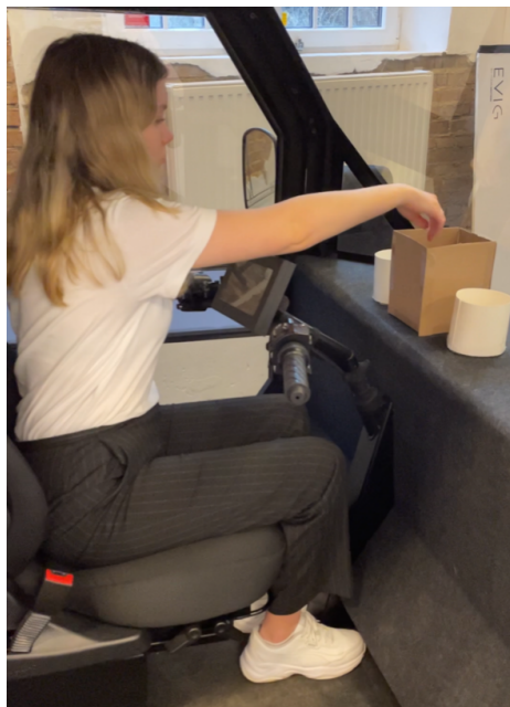
Figur 30: Egentagen bild på sekvens då mugghållaren är placerad på instrumentbräda med framdragen stol.
