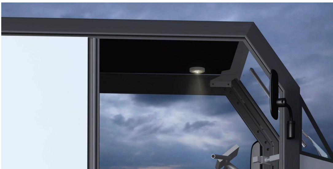
Figur 49: Renderad bild i CAD-programmet Catia V5 som redovisar lampans funktion.
