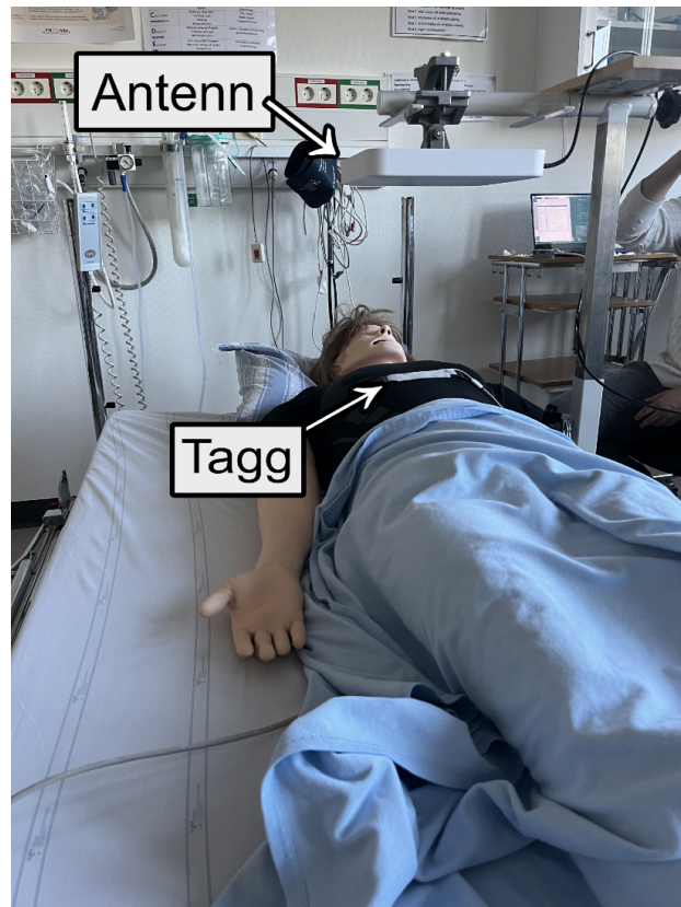
Figur 3.8: Antenn positionerad rakt ovan tagg med 30cm distans.
