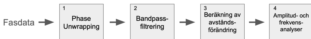
Figur 3.1: Blockdiagram av signalbehandlingsmetoden med fyra steg.
