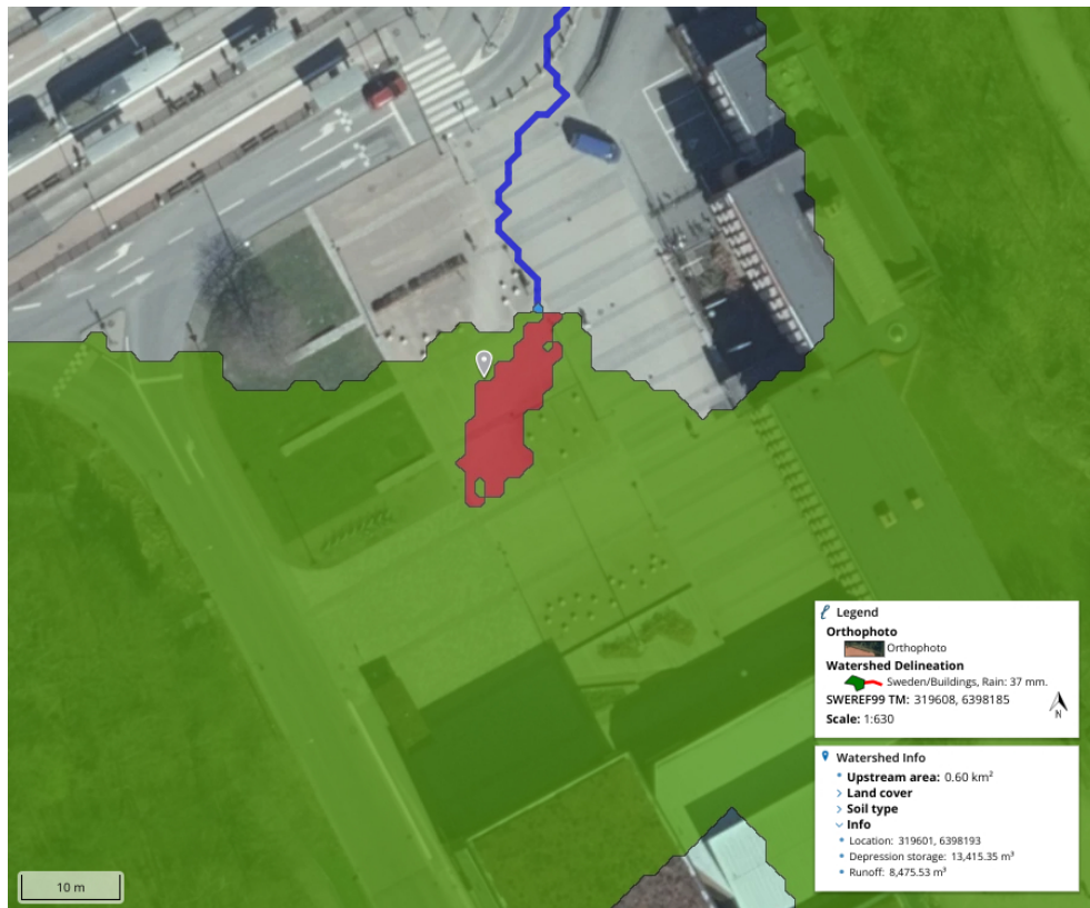
Figur 24: Inzoomad vy över Chalmersplatsen vid regnbelastning om 37 mm via SCALGO. Det röda området representerar lågpunkten, flödesvägen syns i och med den blå linjen.
