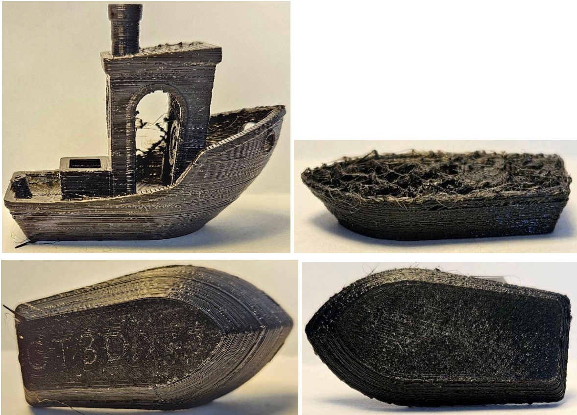
Figur 3.6 - TPU - Direct drive utskriften till vänster och bowden till höger
