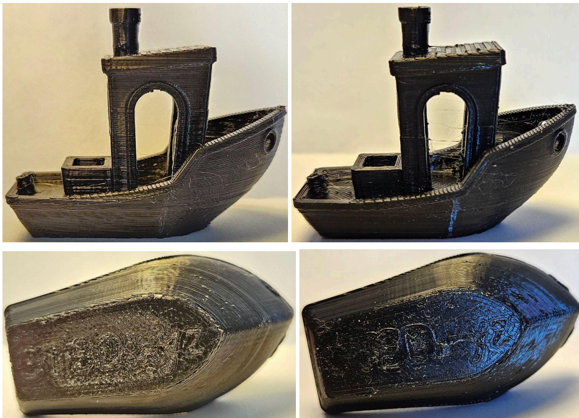
Figur 3.5 - PETG - Direct drive utskriften till vänster och bowden till höger
