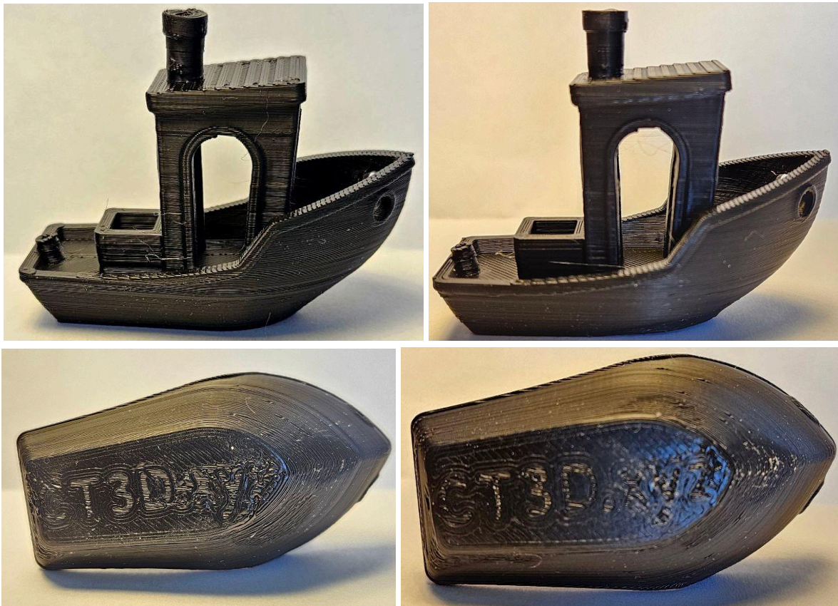
Figur 3.4 - PLA - Direct drive utskriften till vänster och bowden till höger
