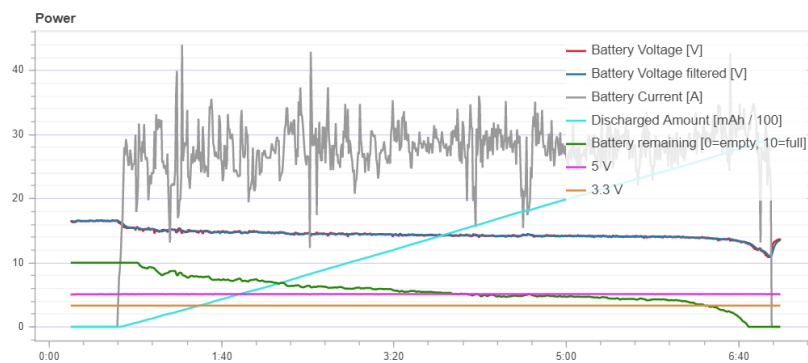
Figur D.8: Batterinivå under uthållighetstest
