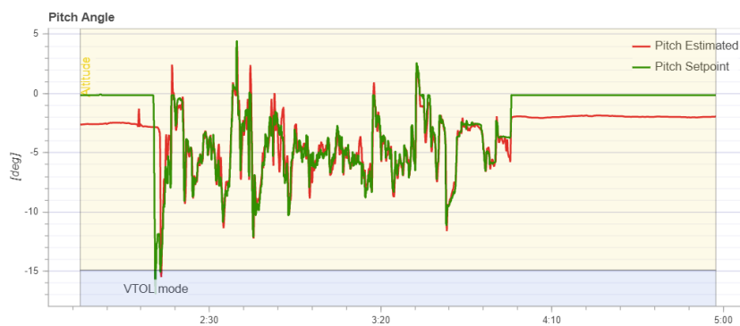
Figur D.3: Jämförelse mellan uppmätt flygdata och börvärde av pitch under altitudtest
