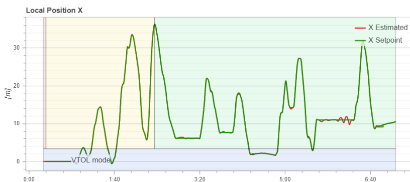
Figur D.5: Jämförelse mellan uppmätt flygdata och börvärde i x-led under positionstest
