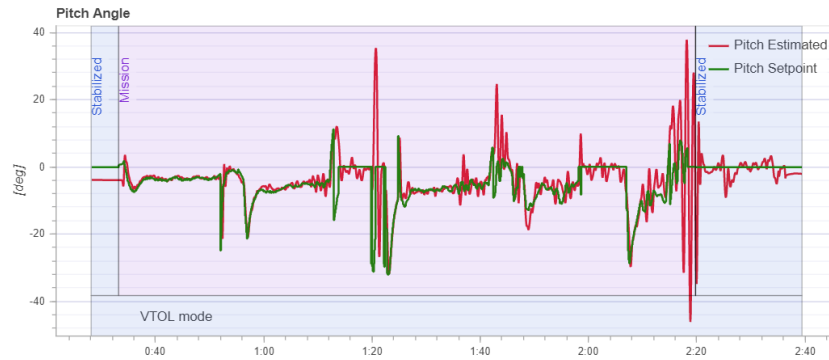
Figur D.9: Jämförelse av pitch mellan uppmätt flygdata och börvärde under rutföljningstest 1
