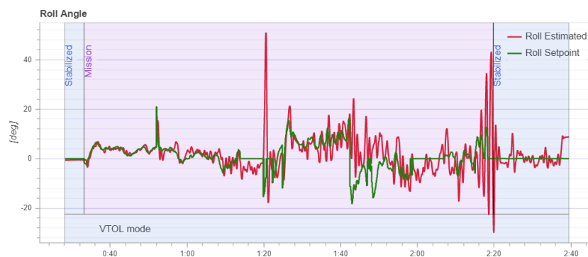
Figur D.11: Jämförelse av roll mellan uppmätt flygdata och börvärde under rutföljningstest 1
