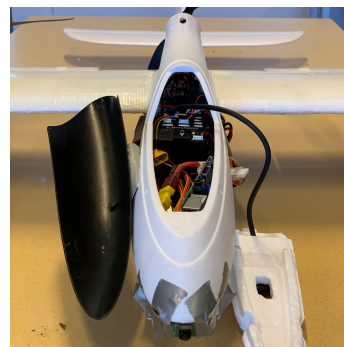
(d) Fästen för kolfiberstänger och ESC
