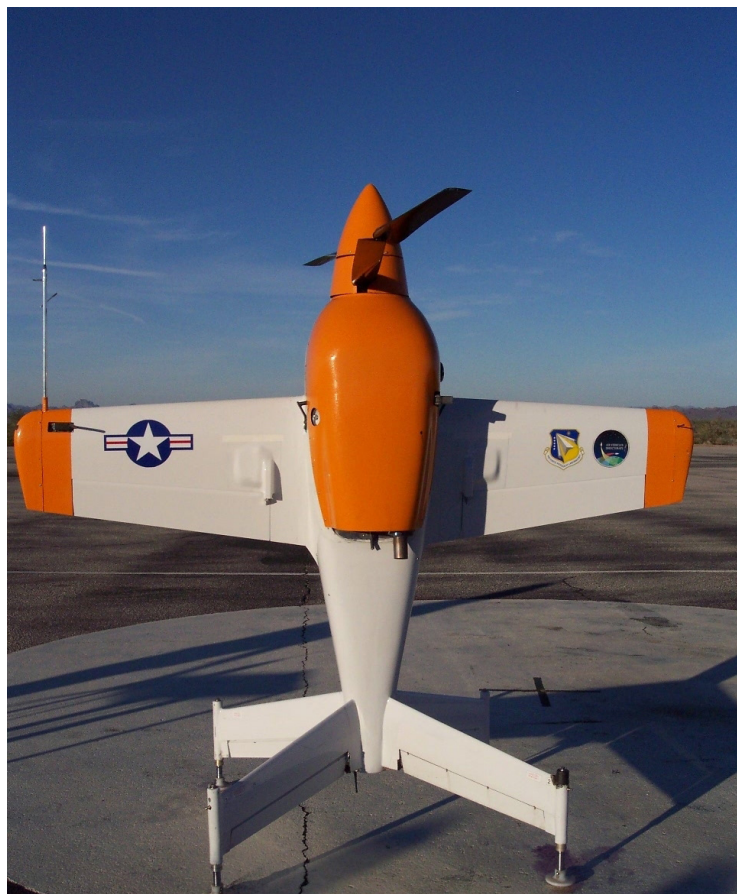
Figur 2.3: En tailsitter-drönare. Från [22].
