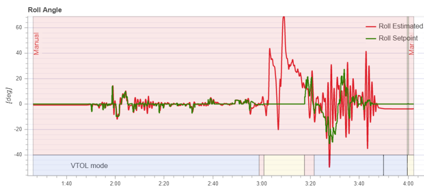
Figur D.26: Jämförelse av roll mellan uppmätt flygdata och börvärde under flygplanstest 1
