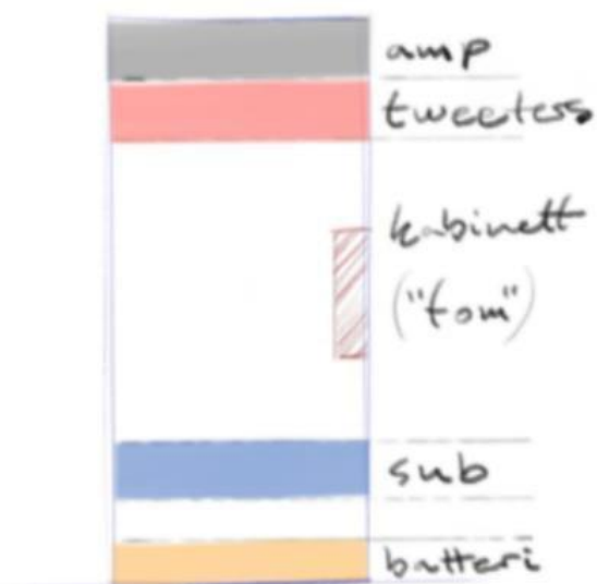
Figur 86: Exempel på layout av komponenter
