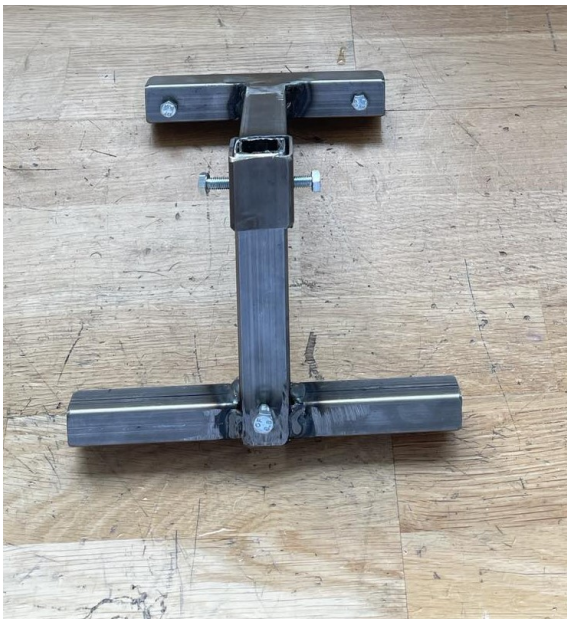
Figur 3.21: Fästeanordningen med stoppskruv på vertikalt rör.
