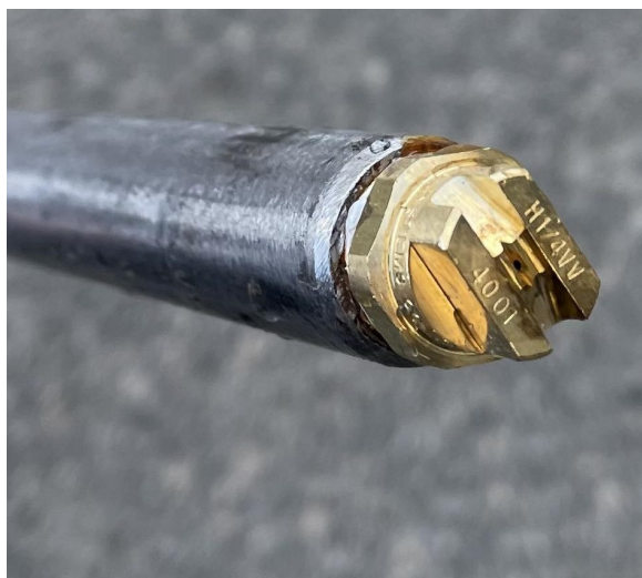
Figur 3.15: Munstycke 40-010 1/4gängat i röret.
