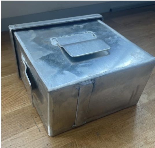
Figur 3.19: Behållarens undersida med fastsvetsad remsa för lutning.
