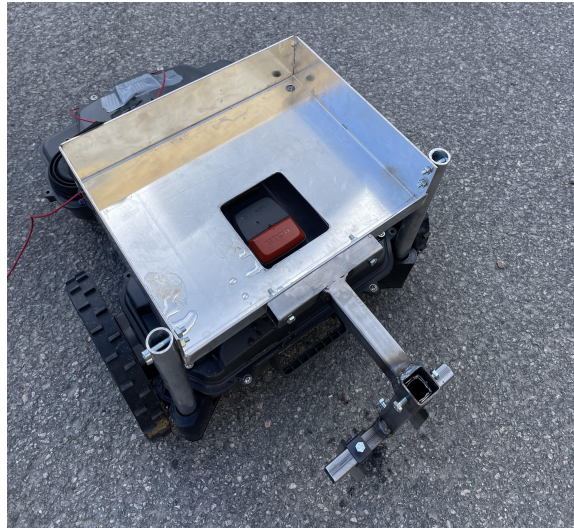
Figur 3.18: Lådan monterad på gräsklipparen.
