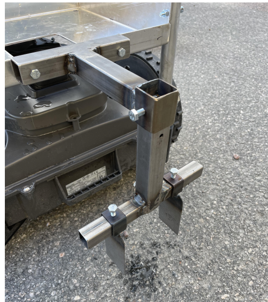
Figur 3.22: Fästeanordningen monterad i lådan på gräsklipparen.
