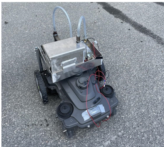
Figur 3.25: Kritmekanismen monterad på gräsklipparen framifrån.
