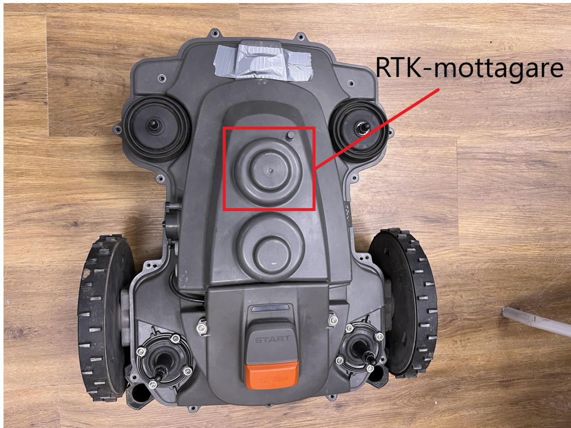
Figur 2.12: RTK-mottagarens position relativt hjulaxeln.
