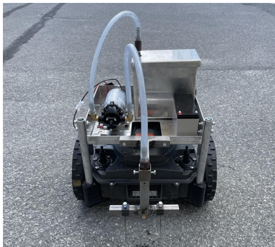
Figur 3.26: Kritmekanismen monterad på gräsklipparen bakifrån.
