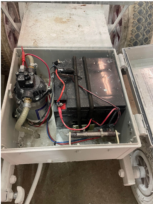
Figur 3.12: PENTAIR SHURflo 8000-543-236 i en elektrisk kritkärra.
