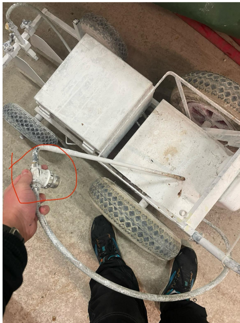
Figur 3.35: Filter till slutprodukt på en elektrisk kritkärra.
