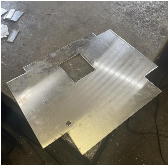
Figur 3.17: Tillklippt plåt till lådan innan bockning.
