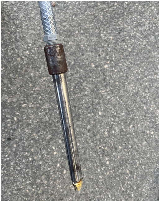
Figur 3.23: Gängat rör att fästa munstycket i.
