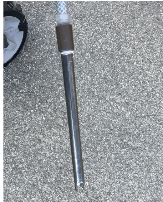
Figur 3.24: Rör att fästa i behållaren för uppsugning av färg.
