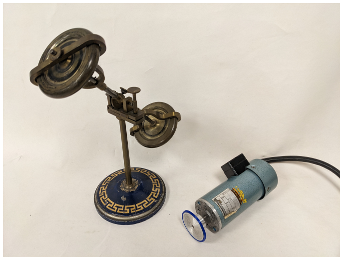
Figur 4.17: Laborationen Gyron som fått en ny o-ring till anbringaren.
