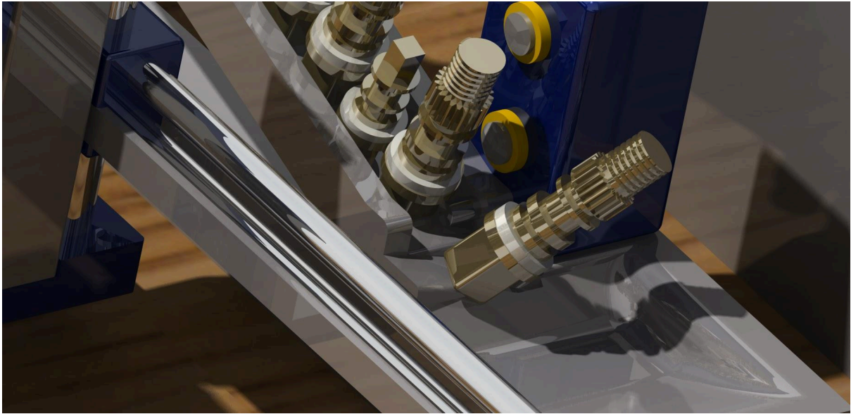
Figur 9.3 är en förtydligande bild på hur en mässingsdetalj trillar ner i skålen. Där en metallstav släpper förbi en mässingsdetalj åt gången.
