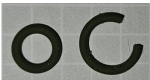
Figur 4.4 visar viton o-ringarna av variant 1 före och efter experimentet.
