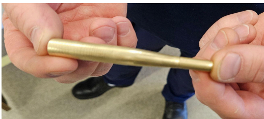
Figur 1.3 Det koniska verktyget som används vid monteringen av o-ringar.
