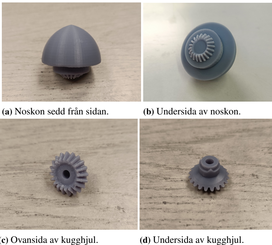
Figur 3.10: Noskon och kugghjul utskrivna med SLA-skrivare.
