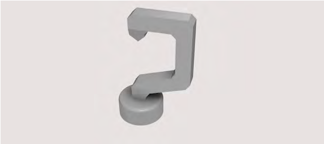
Figur 4.17: Krok med gängor för en PET-flaska att användas för punktlast.
