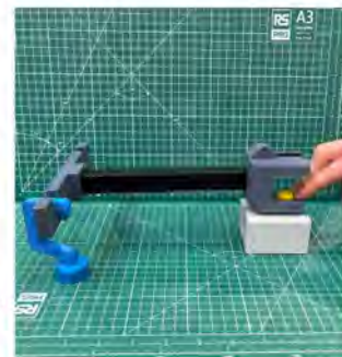
Figur hur experimentet monteras (För experiment fäst riggen i änden på bord)
