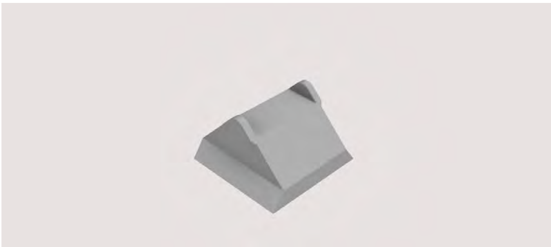
Figur 4.14: Rullstöd för att möjliggöra glidledat stöd vid undersökning av fritt upplagda balkar.
