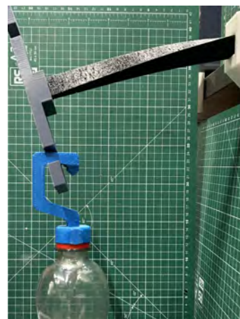
Figur 4.34: Utböjning vid excentrisk last hos balk med T-tvärsnitt.
