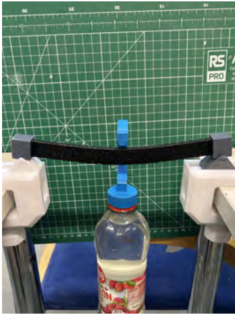
Figur 4.27: Utböjning för en fritt upplagd balk med ett rektangulärt tvärsnitt.
