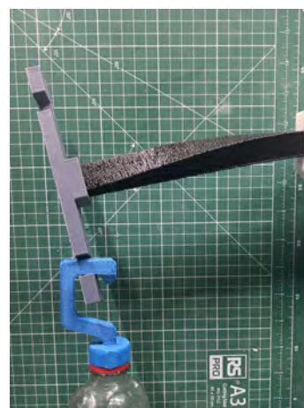
Figur 4.36: Utböjning vid excentrisk last hos balk med I-tvärsnitt.
