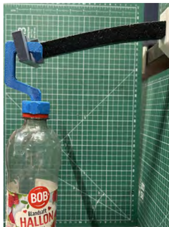
Figur 4.33: Utböjning vid excentrisk last hos balk med kvadratisk tvärsnitt.
