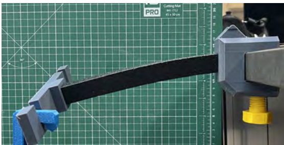
Figur 3.10: Utbøjning med kvadratisk tvärsnitt, fläns och livtjocklek 2 mm i TPU.
