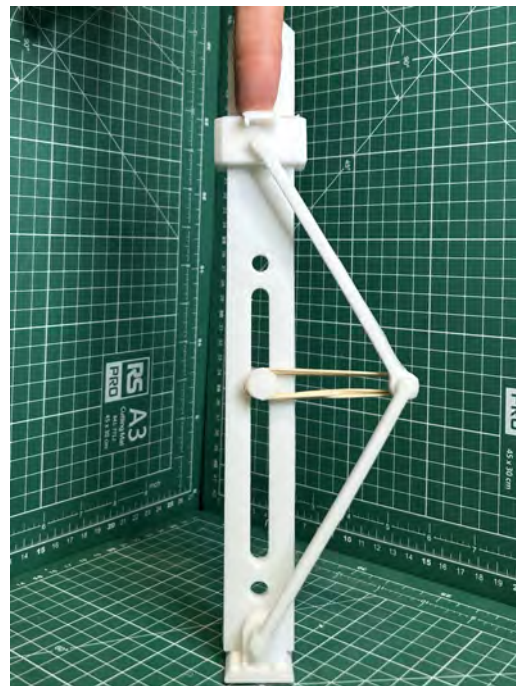
Figur 4.26: Knäckning av fjäderledad balk.
