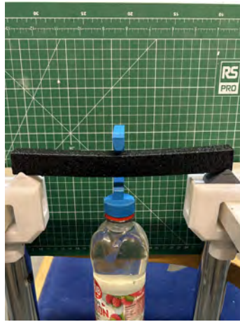
Figur 4.28: Utböjning för en fritt upplagd balk med kvadratisk tvärsnitt.
