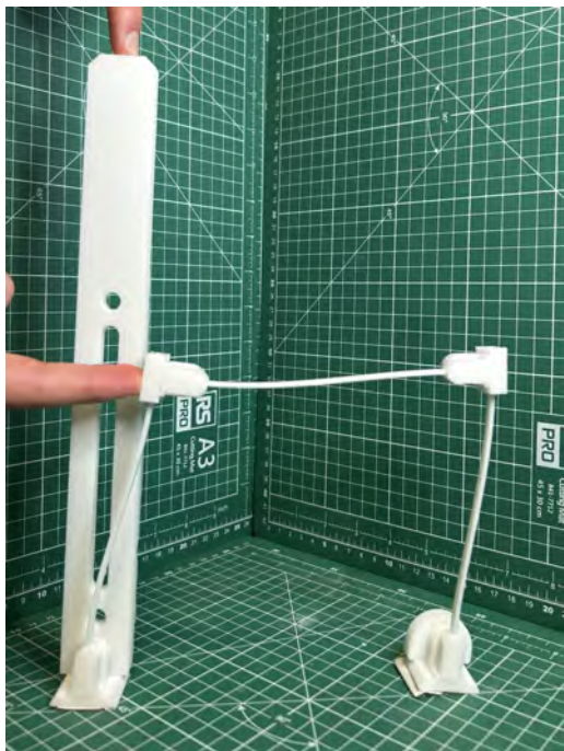
Figur 4.25: Knäckning av en plan ram med hjälp av modellen.
