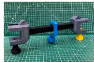
Figur hur fast inspänning monteras (För experiment fäst riggen i änden på bord)
