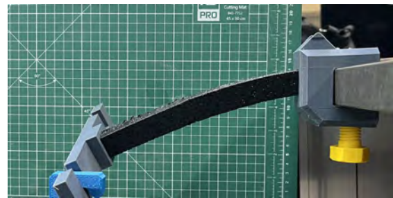
Figur 3.11: Utbøjning med kvadratisk tvärsnitt, fläns och livtjocklek 1.5 mm i TPU.
