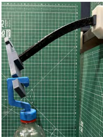
Figur 4.32: Utböjning vid excentrisk last hos balk med rektangulärt tvärsnitt.
