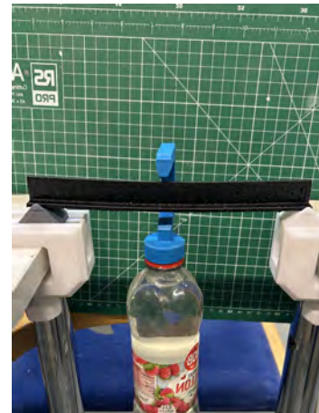
Figur 4.29: Utböjning för en fritt upplagd T-balk.
