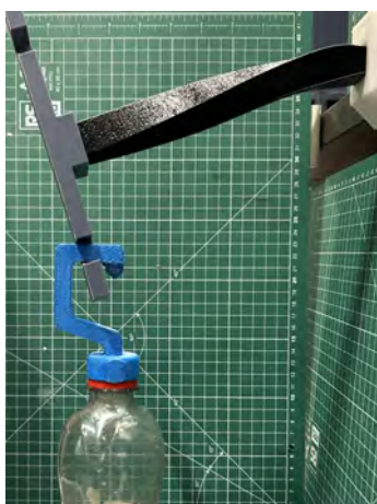
Figur 4.35: Utböjning vid excentrisk last hos balk med C-tvärsnitt.
