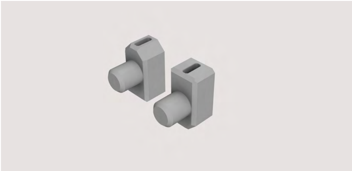
Figur 4.4: Balkfästen i två olika orienteringar. Används för att illustrera varierande typer av inspänningar av knäckstaven.
