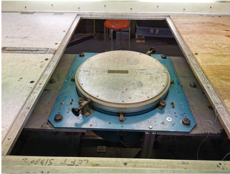
Figur 3.4: Chalmers vindtunnels våg är placerad under vindtunnelns golv och mäter krafterna vilka uppstår på testobjektet.
