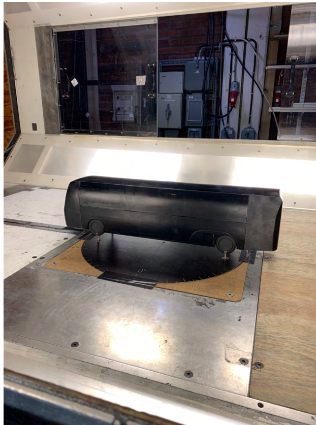
Figur 3.5: Bussen monterad i en 0^\circ vinkel mot flödet i vindtunneln.
