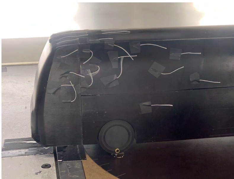
Figur 3.10: En visualisering av flödet med hjälp av garn som tejpats fast på bussen.
