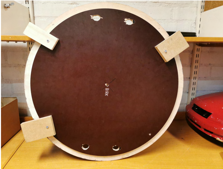
Figur 3.15: Bild på den nuvarande lösningen för inspänning av bottenplattan/gradskivan som används vid vindtunneltester av den aktuella bussmodellen. Observera att en träbit saknas i det nedre-högra hörnet.
