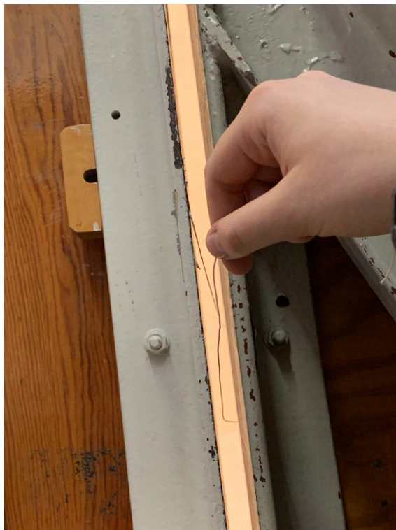
Figur 3.9: Användning av en tråd för att bestämma om vindtunnelns breather slot har ett in- eller utflöde av luft.
