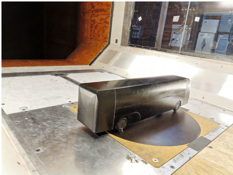
Figur 3.6: Bussen monterad i en 90^\circ vinkel mot flödet i vindtunneln.
