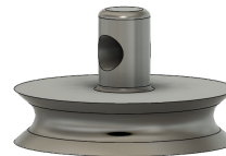
Figur 3.22: Modell av en rörlig trissa som inte fixeras i väggen. Trissan har en liten plugg med hål i sig.
