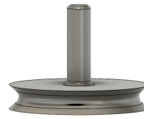
Figur 3.18: Uppdaterad modell av en trissa där "fillet" har använts för att runda kanterna.
