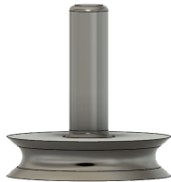
Figur 3.19: Trissa vars dimensioner uppdaterats till en mindre diameter.
