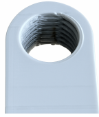
Figur 3.37: Imperfektioner som uppstod i taket på gängorna vid utskrift.
