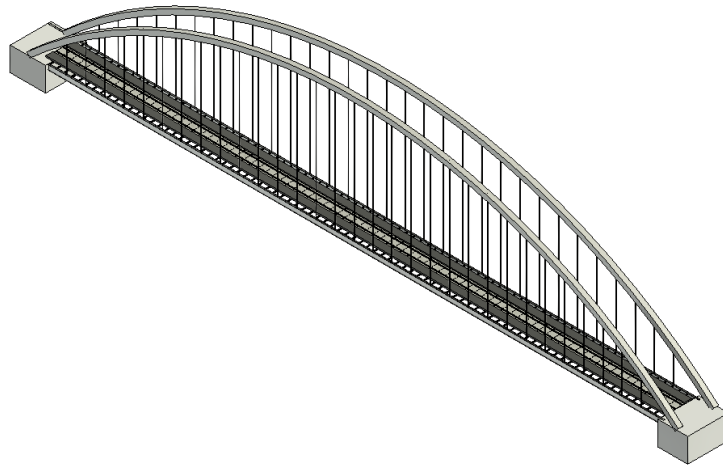
Figur 2.1: Bro med överliggande båge av betong
