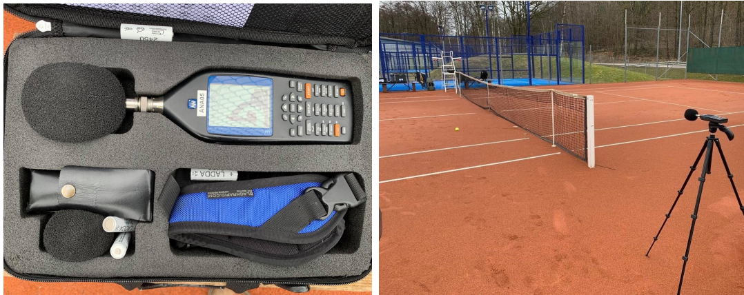
Figur 3.2.2: Vänster: Ljudmätare av modell Norsonic NOR139 som användes vid mätning och inspelning av ljud (egen bild).
