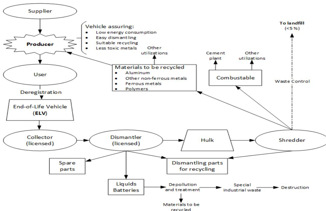
Figure 1: ELV Recycling Process (kanari et al., 2015)
