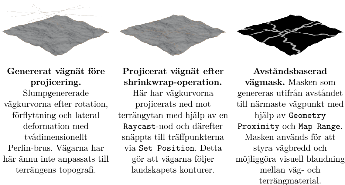
Figur A.2: De olika stegen i genereringen av vägnätet. Först skapas ett slumpmässigt slingrande vägnät med Perlin-brus, därefter projiceras vägarna mot terrängytan med en shrinkwrap-liknande operation, och slutligen genereras en avståndsbaserad mask som används för att representera vägbredd och materialblandning.
