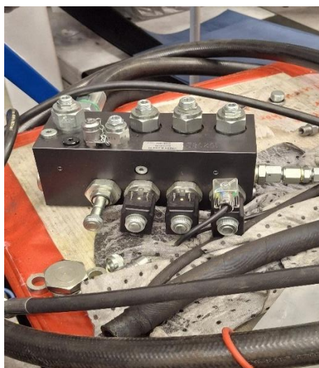
Figur.1 Det befintliga Ventilblocket som användes för LS-signaltestning
