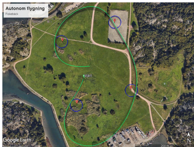
Figur 6.1: Autonom flygning utförd vid Sjöbacken Fiskebäck. Den långa linjen visar drönarens flygning. Markeringarna med cirklar indikerar utsatta vägpunkter och deras toleransradie visas med cirkeln. Flygbild © 2018 Google.
