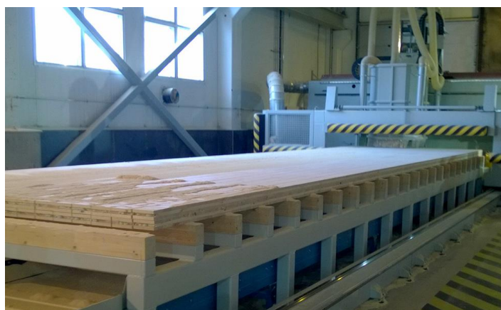
Figur 4: Bearbetning av KL-träskiva i CNC-maskin, Computer Numerical Control, Foto Anders Gustafsson (svenskt trä,u,å,b)
