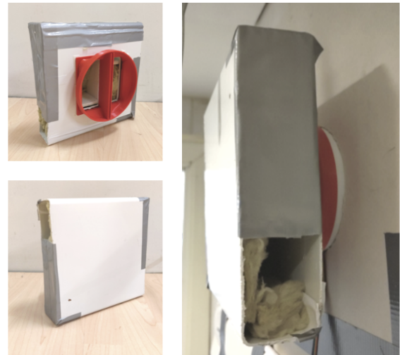
Figur 34. Funktionsmodell samt skiss av "Absorberande Kvadratisk"
