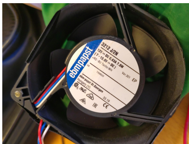
Figur 14. Produktens fläkt, ebm-papst 3212 J/2N.
