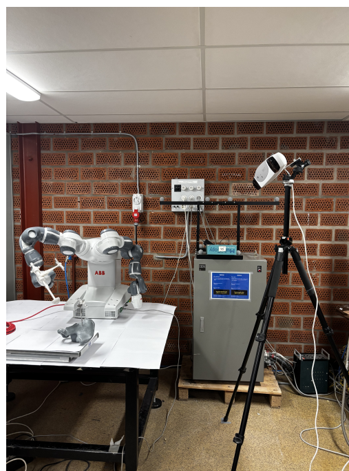
Figur 25: Experimentuppställningen tillsammans med IR-kameran som läser av verktygets och bäckenets position.
