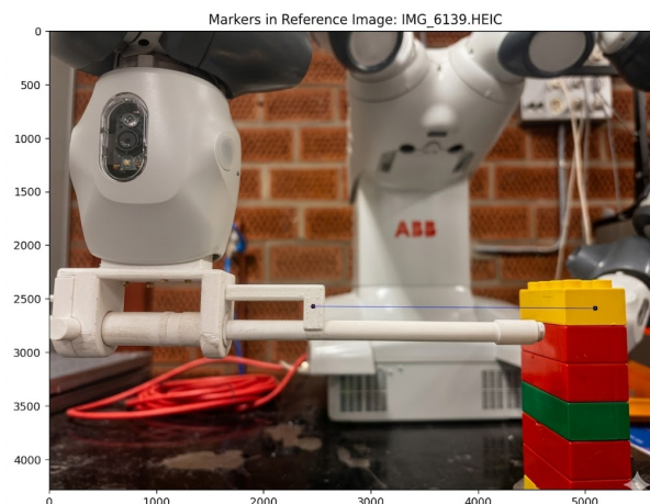
Figur 21: Visualisering av beräknad vektor för längd och vinkelanlys. Bilden visar originalbilden med en överlagrad blå linje. Linjen representerar den vektor som beräknats mellan de två isolerade markörernas tyngdpunkter, se figur 20.
