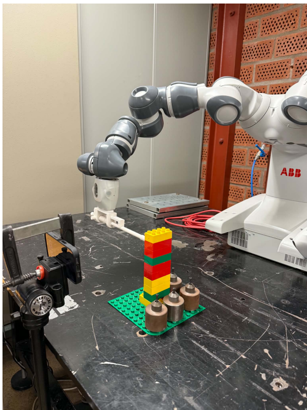
Figur 18: Experimentuppställningen för analys av positionsvariation och vinkelvariation i X-led. Två svarta prickar, en på greppsystemet och en på det stationära referensobjektet, användes som markörer. Som kamera användes en Iphone 17.
