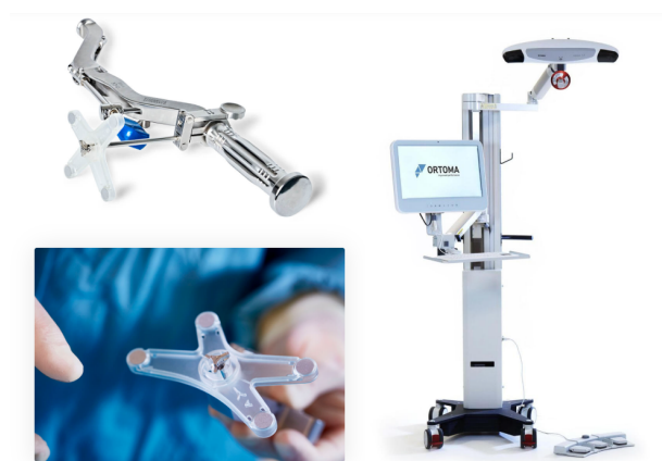
Figur 4: Till höger i figuren syns Ortomas IR-kamera och till vänster syns det konventionella medicinska verktyget för manuell positionering vid operation, samt en förstoring av riktningsgivaren. Tillsammans möjliggör dessa komponenter realtidsvägledning under operationen. Bild från Ortoma: [21].
