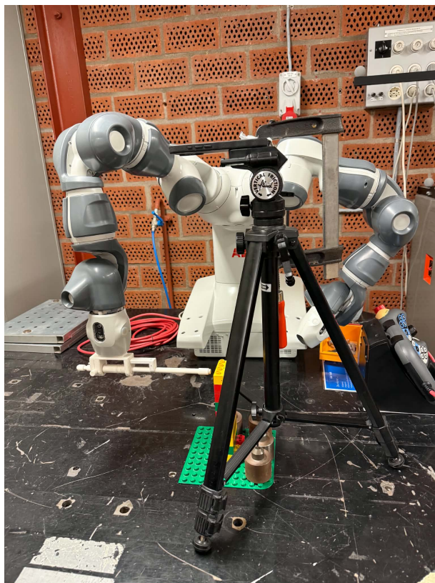
Figur 19: Experimentuppställningen för analys av vinkelvariation i Z-led. Här är markörerna flyttade så att de syns från den nya kameravinkeln.
