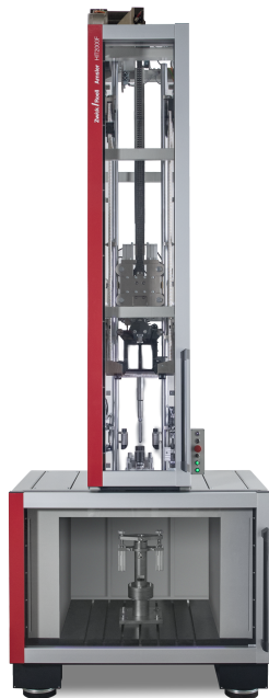
Figur 2.6: Exempel på giljotinmodell (Zwick/Roell, 2025).
