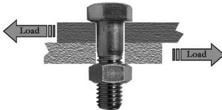
Figur 2.1: Bult utsatt för skjuvning (Fastenal, 2009)
