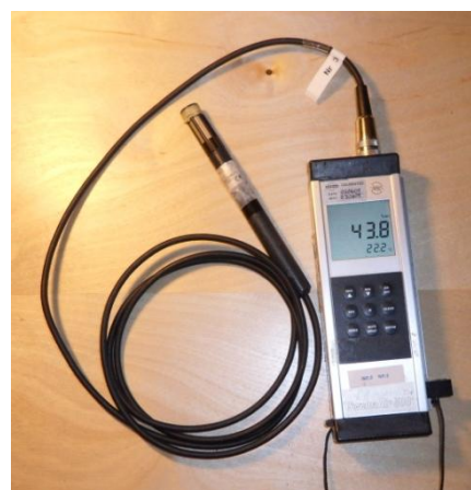
Figur 3: Mätinstrumentet Swema Air 300 med vilket den relativa fuktigheten och temperaturen i luften mäts.
