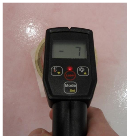
Figur 56: IR-termometerns utslag mot maskeringstejpen med emissionsfaktorn 0,95.
