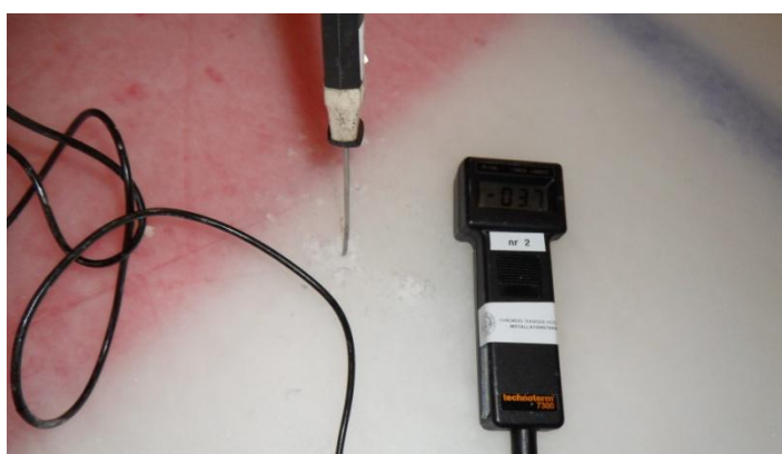
Figur 53: Mätsonden stoppas ner till botten av hålet och temperaturen bestäms.
