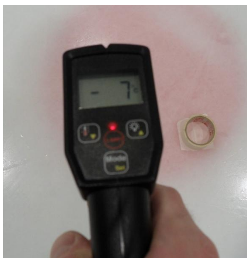
Figur 55: IR-termometerns utslag mot isen med emissionsfaktorn 0,95, intill en yta där maskeringstejp legat mot isen i ca 30 min.
