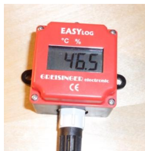
Figur 2: Loggern EASY LOG 24RFT som användes för att registrera mätvärden på läktarna.
