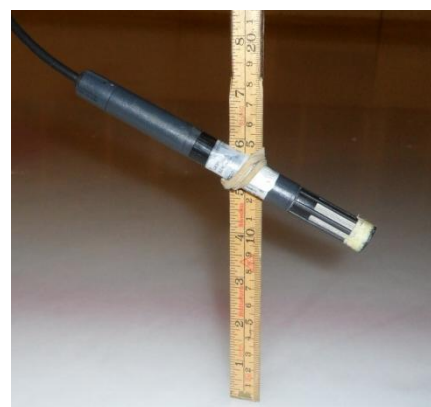
Figur 4: Fukt (och temperatur) -givaren fäst med ett gummiband på en måttstock under ett måttillfälle i Åby ishall.
