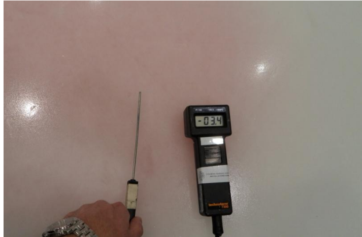
Figur 57: Mätsonden trycktes mot isytan under ca 5 min, varefter mätvärdet lästes av.
