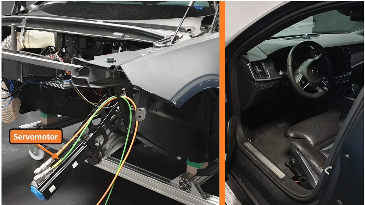
Figur 5: Servomotor vars axel är kopplad till en bilratt
