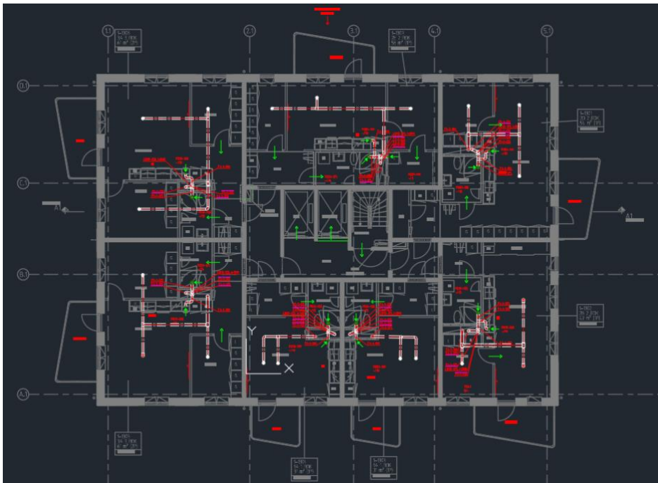
Figur 8: Om projektering av given kanaliseringsritning till FTX system i Magicad for Autocad.
