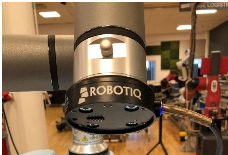
Figur 6, Wrist Camera installerad på UR3e [20]
