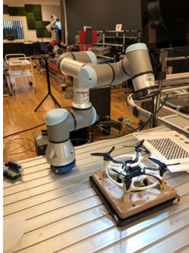
Figur 9, Automatiskt system (UR3e+kamera) och testobjekt (Drönare),[20]
