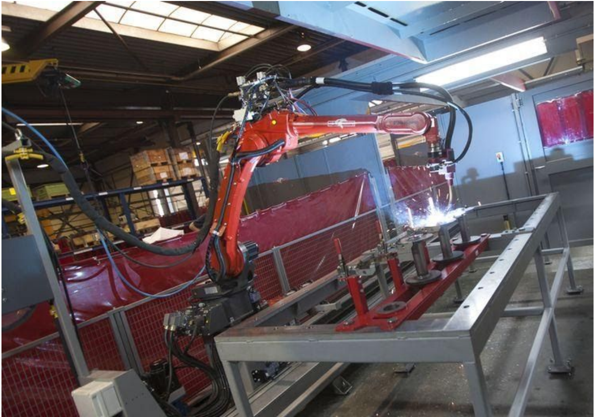
Figur 2, Industriell robot svetsar i ett skyddat område [11]
