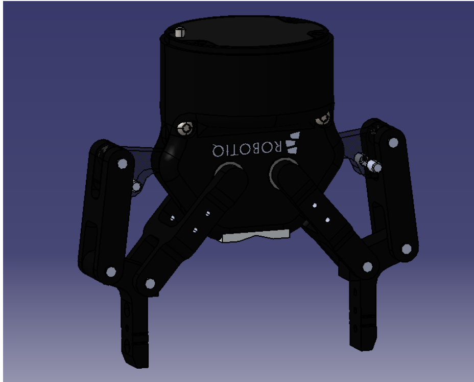
Fig 5.12. CAD-modell av gripdonet 2-finger 85 från Robotiq.
