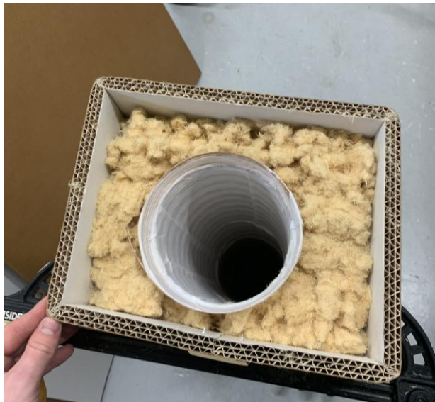
Figur 1313: Fyllning av ljuddämparen CLA.
