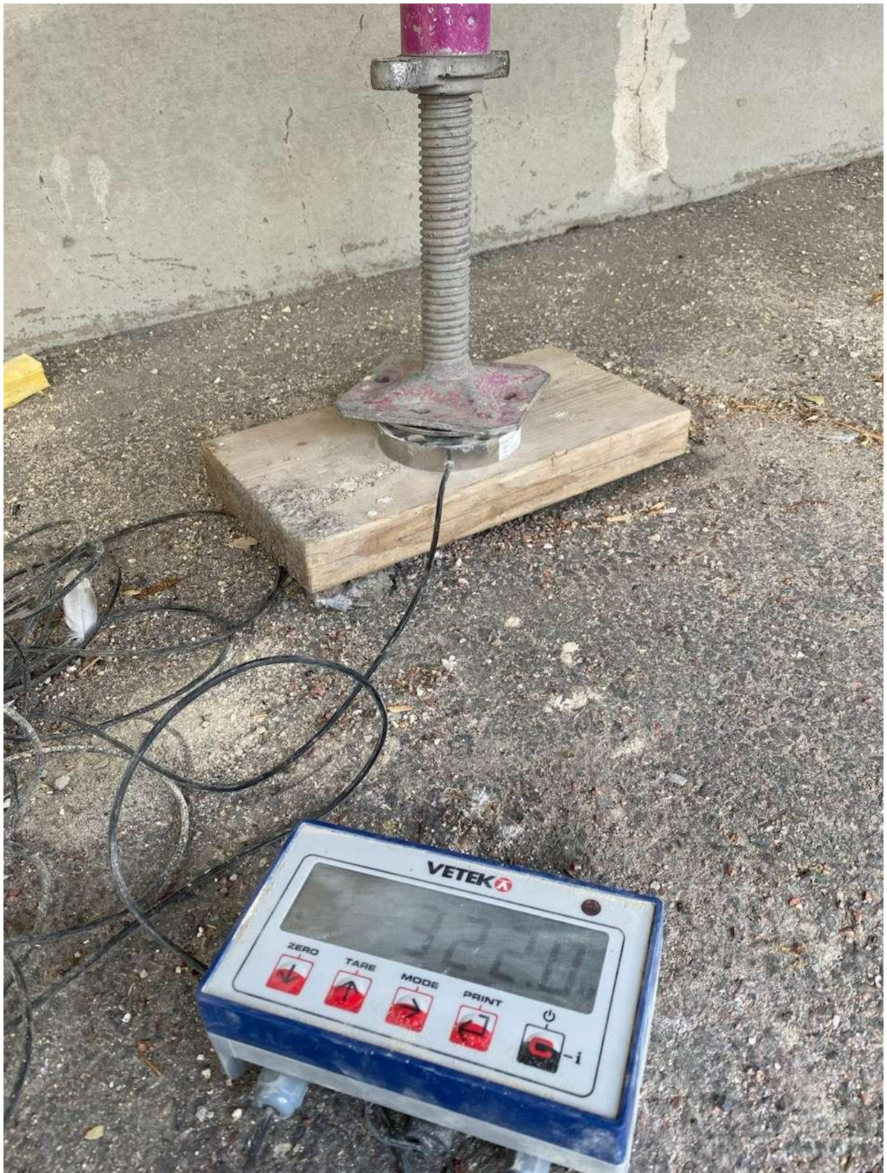
Bilaga C.1: Lastcell monterad under en spira
