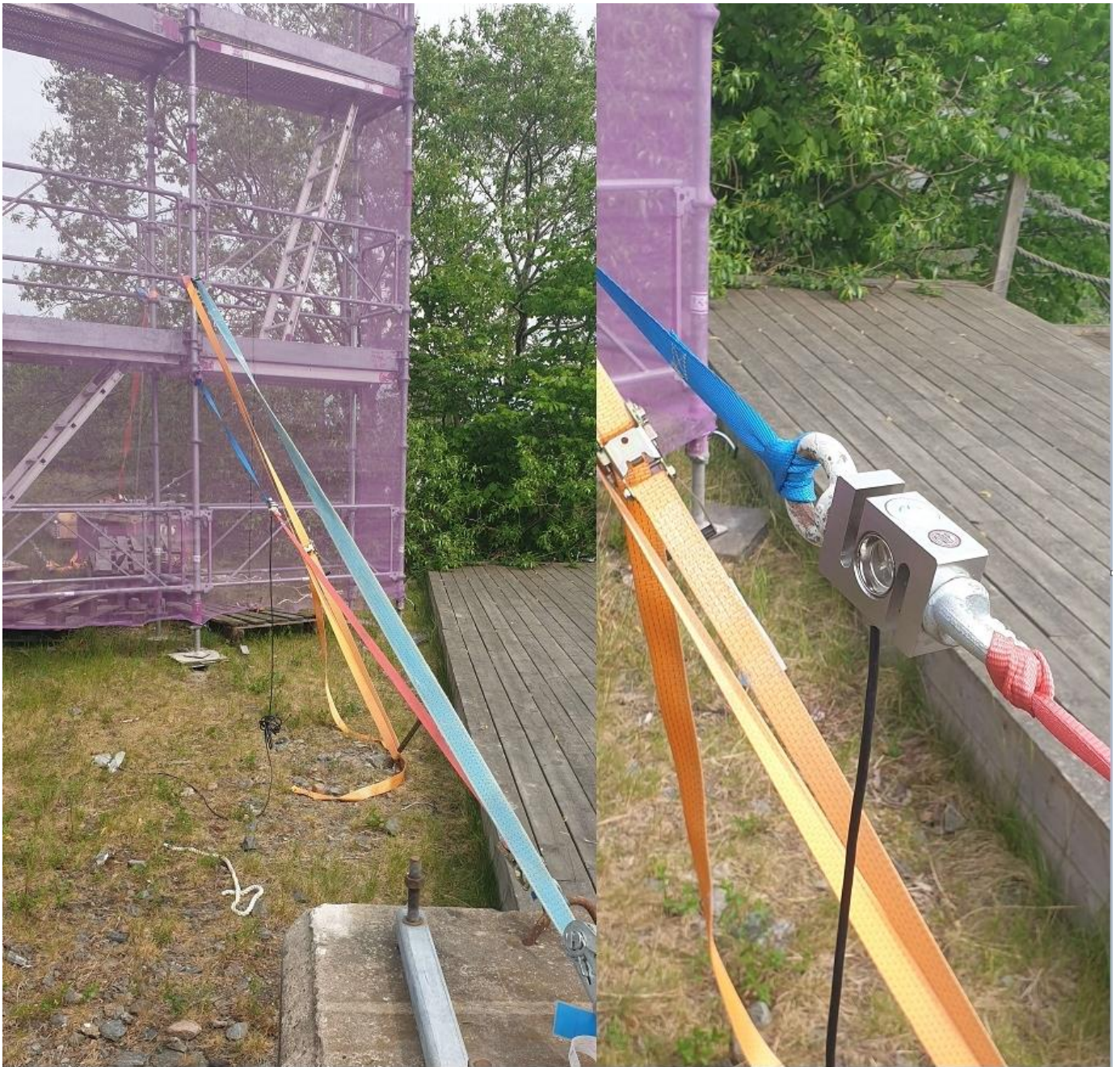
Bilaga C.4: Kraftmätare monterad i förankring för referensobjekt gården
