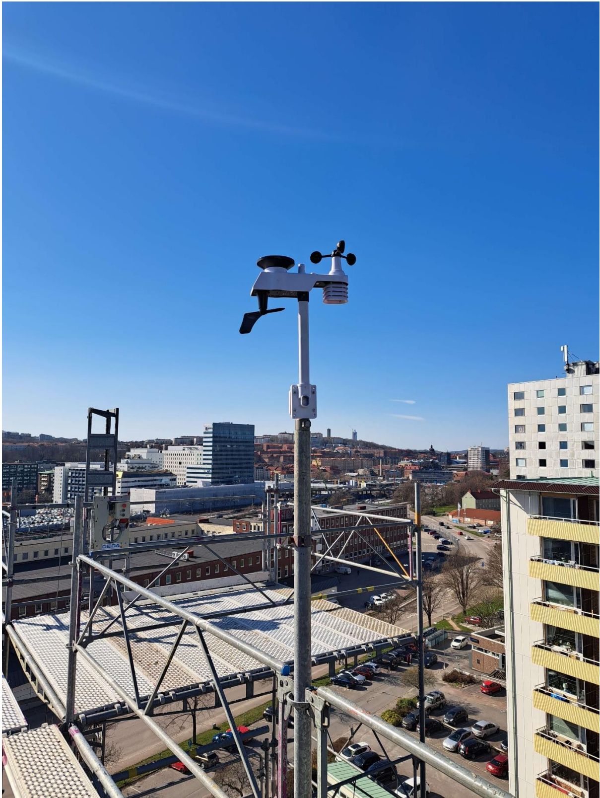
Bilaga C.3: Vindmätare monterad på toppen av en byggställning
