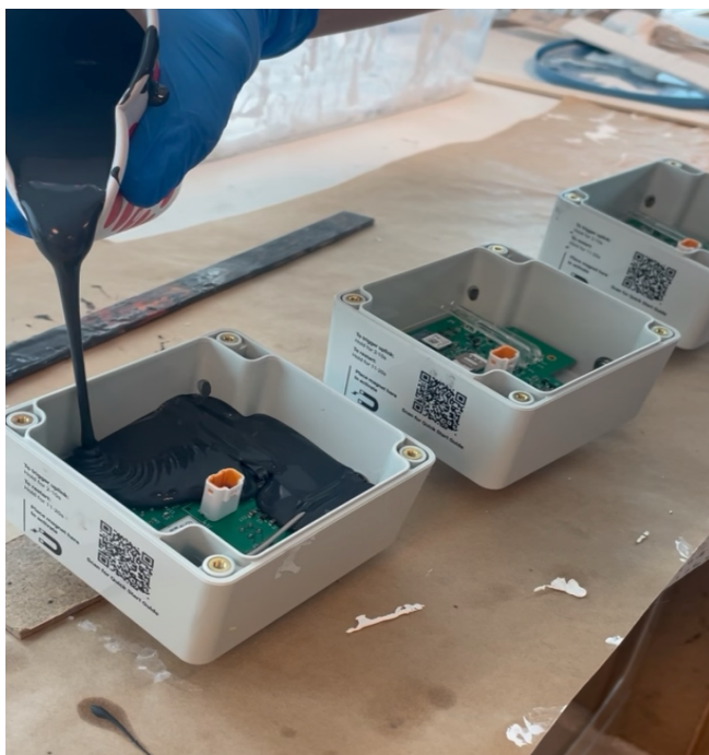
Bild 4.3. Fördelning av gjutmassa. Närbild av gjutningsmomentet. Bilden indikerar hur gjutmassan fördelas i kapslingen och täcker kretskortet. Foto: författarna.
