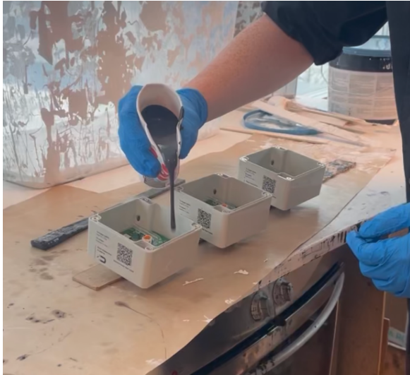
Bild 4.2. Applicering av gjutmassa i kapsling. Gjutmassan hälls över elektroniken för att skydda komponenterna. Foto: författarna.
