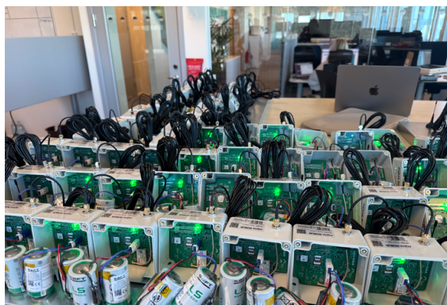
Bild 4.1. Masstest av enheterna. Enheterna är placerade på metallplattor och uppkopplade för kontroll av funktion och signal. Foto: författarna.
