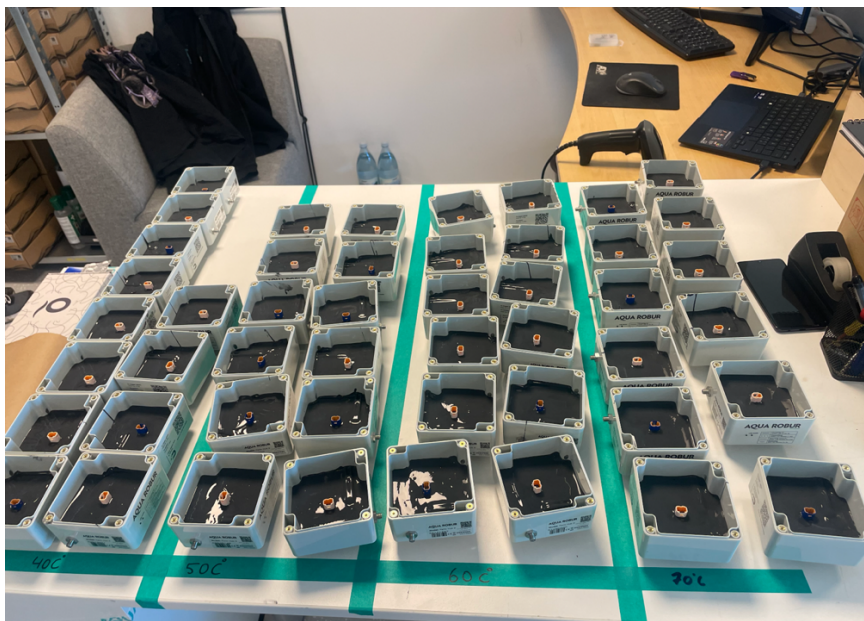
Bild 5.1. Enheter efter genomfört gjutningstest. Enheterna är uppdelade efter olika temperaturförhållanden för att jämföra hur gjutmassan påverkas under härdning. Foto: författarna.
