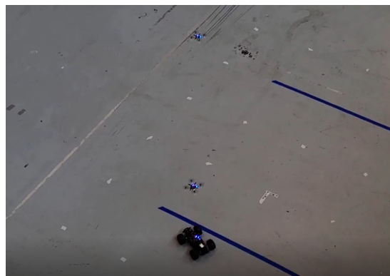
Figur 7.3: Övergång mellan områdesavsökning och målsparning i praktisk testmiljö. Den övre drönaren genomför avsökning enligt en Lissajousbana, den undre drönaren hoverar ovanför inkräftaren (RC-bilen) för att övervaka dess position.
