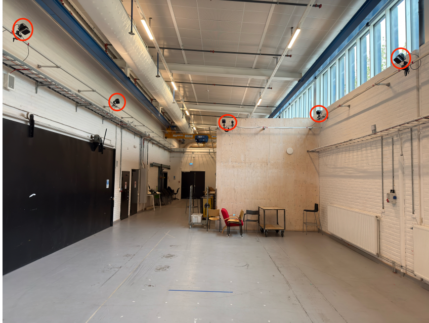
Figur 2.1: Bilden visar eventhallen där Mocap-systemet befinner sig, fem av systemets totalt åtta kameror är inringade i rött.
