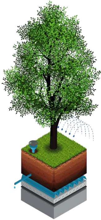
Figur 3 Illustrationen visar en överbyggnad på tätskikt och bjälklag bestående av vegetation, växtbädd, bevattning, dränering, avvattning, skyddstextilier och avslutningsvis en rotspärre (Illustration: Patrik Granqvist från Boverket, 2021). Återgiven med tillstånd.
