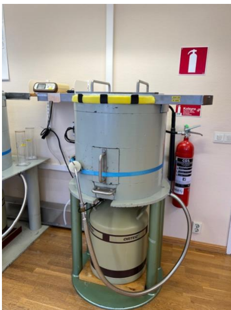
Figur 5. HPGe-detektor använd vid gammaspektrometrisk analys av proverna.
