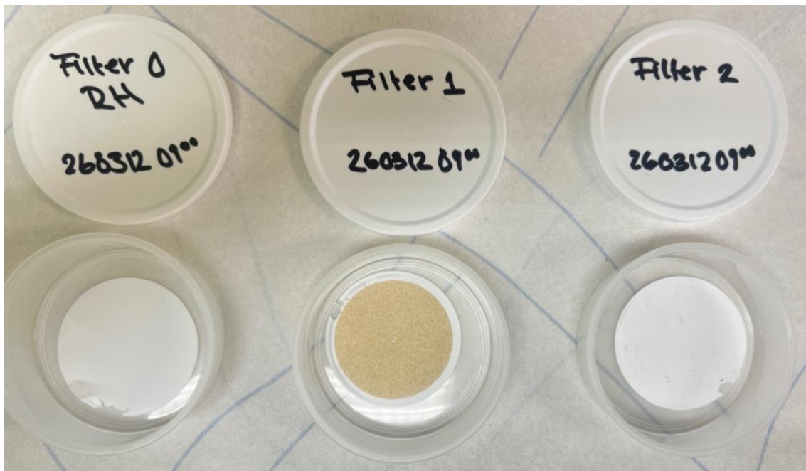
Figur 8. Fotografi av 0,45 \mu\text{m} -filter efter filtrering av RH, vatten, nyberett vatten B samt permeat från 30kDa-filtrering.
