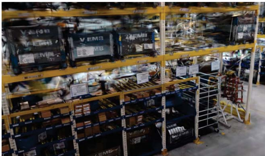
Figur 6.4: Visualisering av 3DGS-modell för hyllor i sektion 1. Den nedre delen är väl rekonstruerad med tydliga detaljer, medan den övre delen uppvisar förvrängningar, vilket indikerar bristfällig bilddata från höga vinklar. Modellen illustrerar hur begränsningar i datainsamlingen påverkar rekonstruktionskvaliteten i olika delar av miljön.
