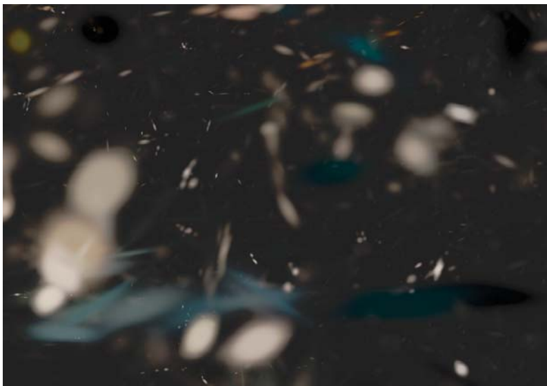
Figur 2.3: Grupp av 3D-gaussians som visar att alla har egen position, form, opacitet och färg.
