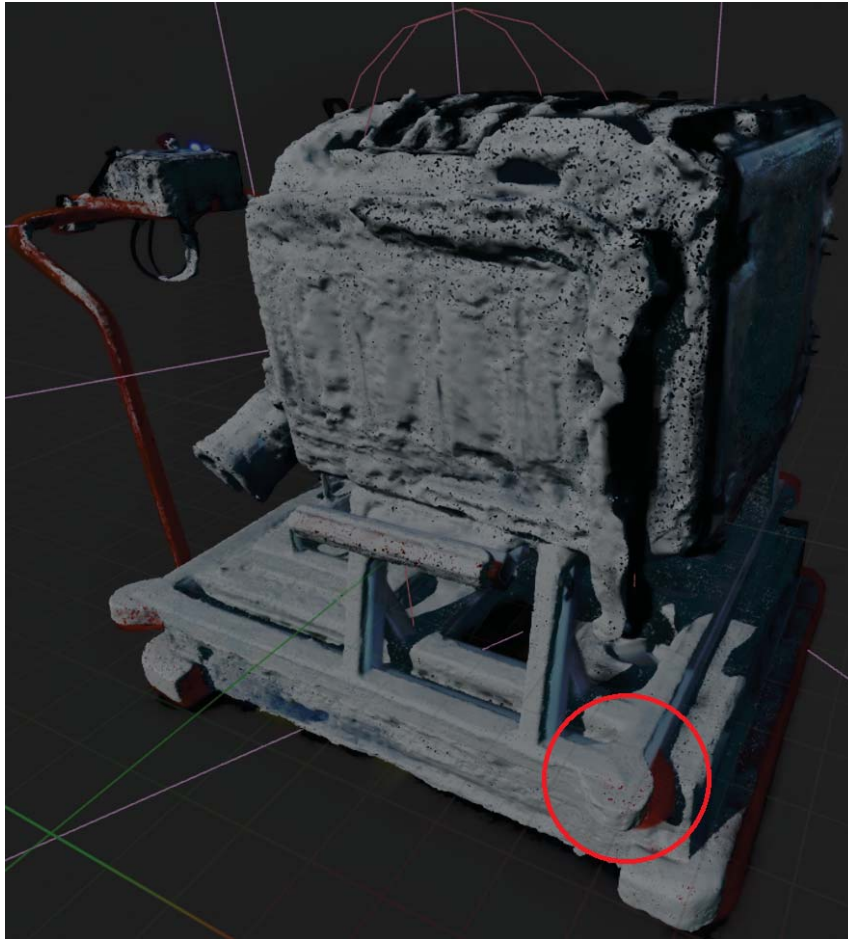
Figur 6.13: Sammanställd karaktär med 3DGS modell och mesh som förtydligar positions- och skalningsdefekterna mellan objekt skapade från två olika punktmoln. Den röda cirkeln visar hur positionen, för den orangea detaljen, hos 3DGS-modellen inte överensstämmer med samma detalj i mesh-objektet.
