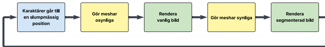
Figur 5.5: Figuren visar det sekventiella flödet för genereringen. Först flyttas karaktärerna till en slumpmässig position. Därefter vill man se till att alla meshar är osynliga innan man renderar den vanliga bilden. Därefter görs mesharna synliga, den segmenterade bilden renderas och processen upprepas.
