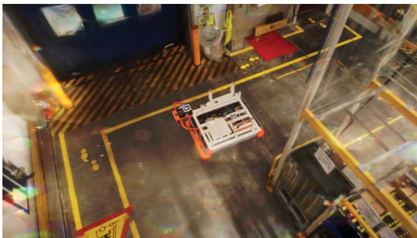
Figur 6.14: Simulerad linsöverstrålning med hjälp av en Dirt Mask-textur i Unreal Engine 5 (UE5). Bilden visar hur en artificiell smutsmask appliceras för att efterlikna optiska störningar i kameranlinsen och öka realism i den digitala miljön.
