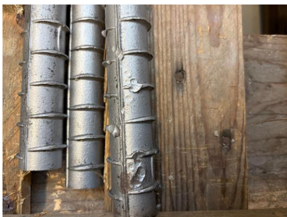
Figur 27 - Foto: Ruben Bång Brunström och Gustav Ekdahl, skador på armeringsjärnen som inte uppstått i följd av korrosion.
