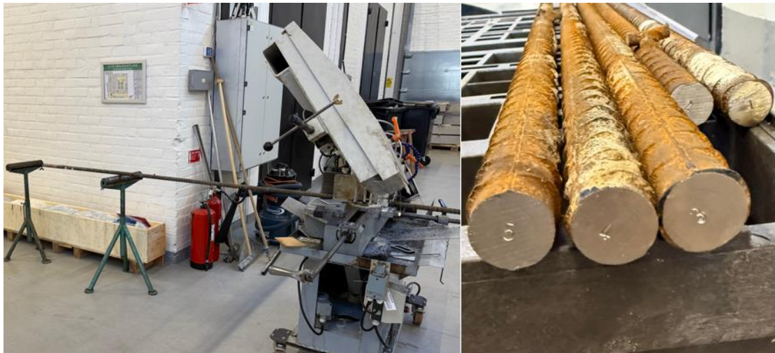
Figur 14 – Foto: Ruben Bång Brunström och Gustav Ekdahl. Kapning av armeringsstängerna och numrering, egna bilder.
