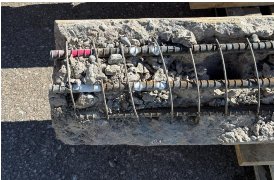
Figur 12 - Foto: Henrik Granroth, armeringsstångernas position i pålen.
