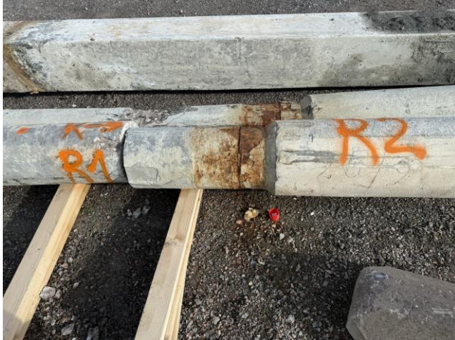
Figur 11 - Foto: Ruben Bång Brunström och Gustav Ekdahl, markering av pålen sektioner och mätning.
