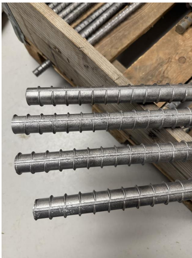
Figur 19 - Foto: Ruben Bång Brunström och Gustav Ekdahl, närbild av korrosionsangrepp på armeringsjärnen.
