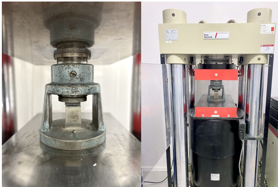
Figur 3.1: Tryckhållfasthetstest av ett murbruksprov
