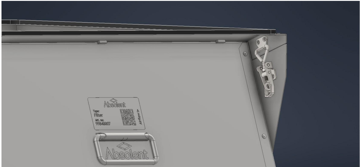
Figur 28, CAD modell av modulen "Excenterlås"
