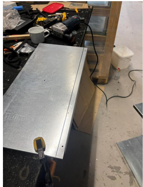
Figur 23, Vinklade profiler sågades ut i plåt
