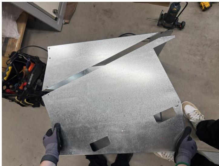
Figur 22, Ett snitt kapades i ramen av den nuvarande lösningen. Vy från sidan
