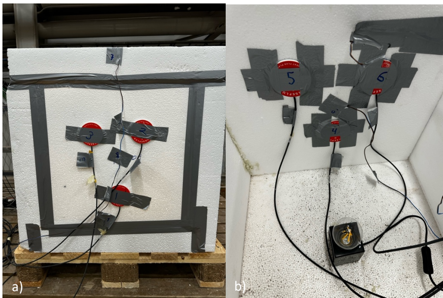
Figur 5: Uppställning av isoleringslaboration där a) visar baksidan med värmeflödesmätare och temperaturmätare. b) visar insidan med värmeflödes-, temperaturmätare och värmekälla.
