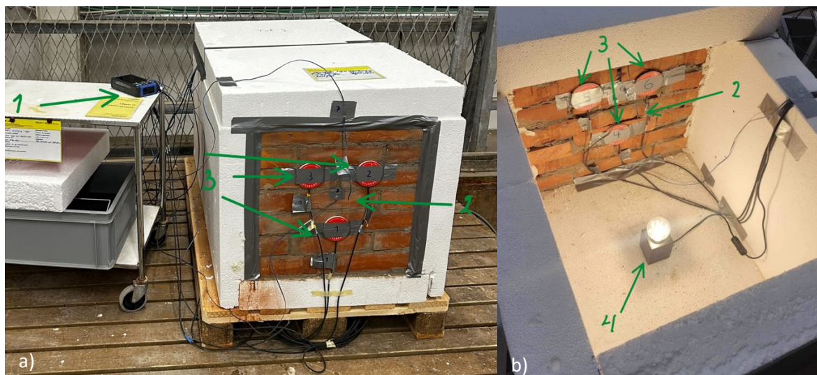
Figur 2: a) Laborationens uppställning sedd framifrån. 1 visar datalogger, 2 visar yt- och lufttemperaturmätare, 3 visar värmeflödessensorer. b) Det uppvärmda tomrummet bakom tegelväggen. 2 och 3 visar samma som för framsidan och 4 visar den interna värmekällan i form av en lågenergilampa.
