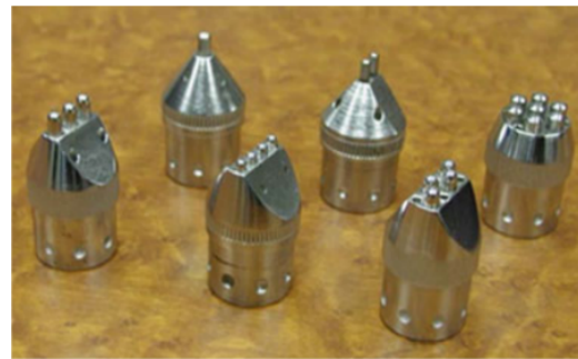
(d) Different indenter modifications
