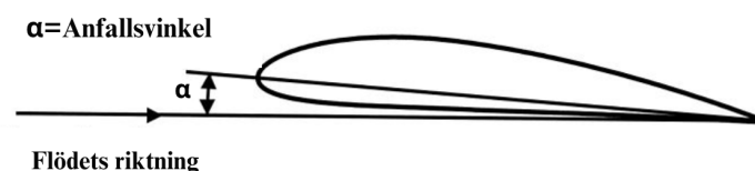
Figur 2.2: Illustrering av anfallsvinkel \alpha (Müller, 2006a).
