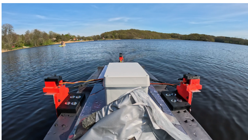
Figur 5.11: Tillfällig lösning för att justera positionen av tyngdpunkten
