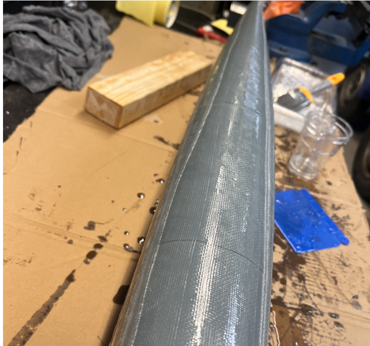
Figur 3.2: Glasfiberlaminering av skrov med epoxy.
