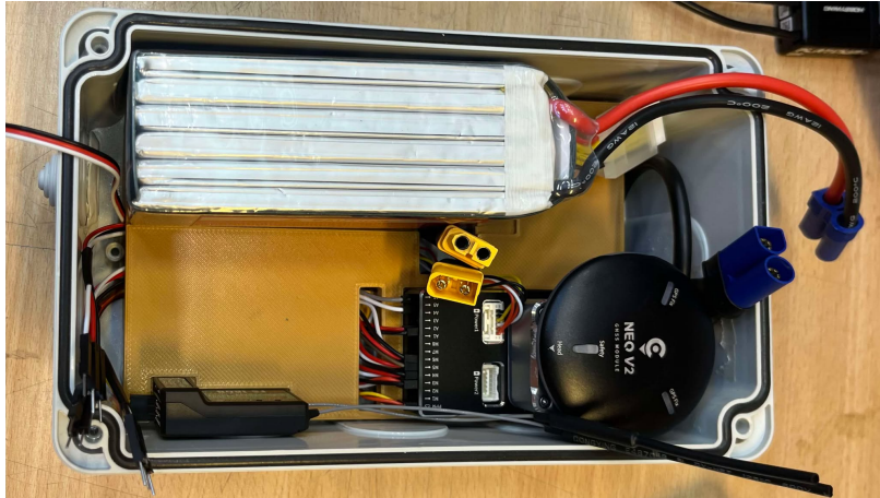
Figur 3.23: Biltema kopplingslåda med plattan och vissa komponenter installerade.
