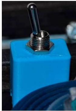
Figur 2.4, 3D-utskrivet hölje för vippströmbrytaren
