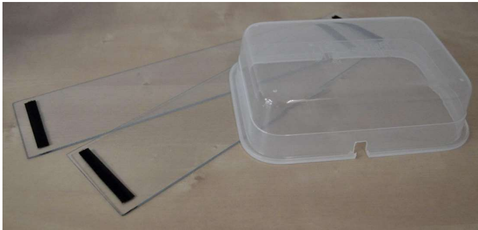
Figur 4.16, Skydd över elektronik samt motorutrymmen avplockad från skrovet
