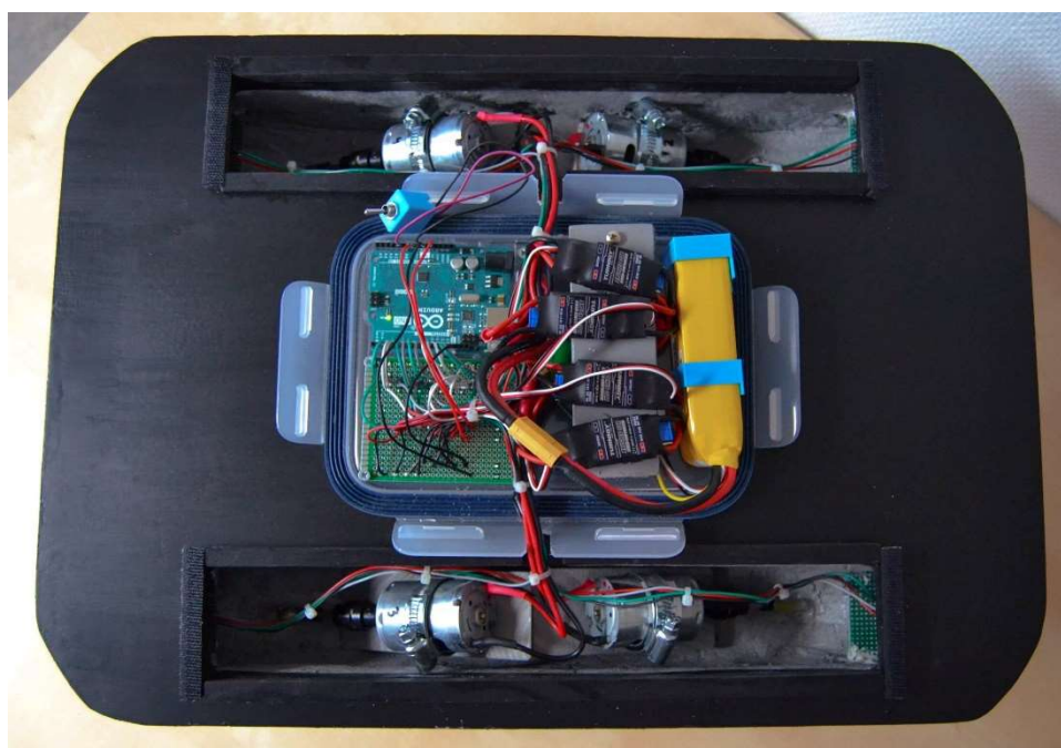
Figur 4.3, Färja ovanifrån utan dess skydd, visar elektronikkomponenterna.
