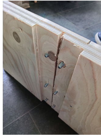
(b) Delvis demonterad dubbellask-koppling
