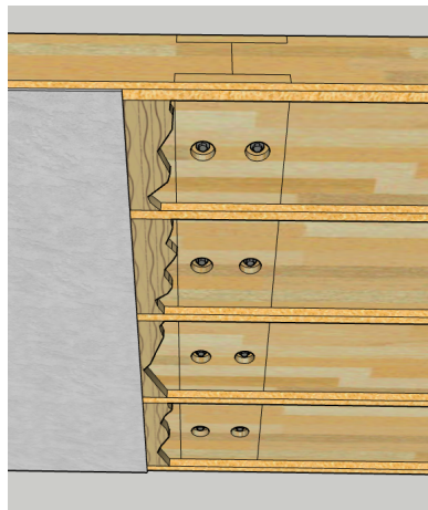
Figur 57: 3D-modellering av dubbellask med vagnsbult (Skärmdump från Google Sketchup, 2021)
