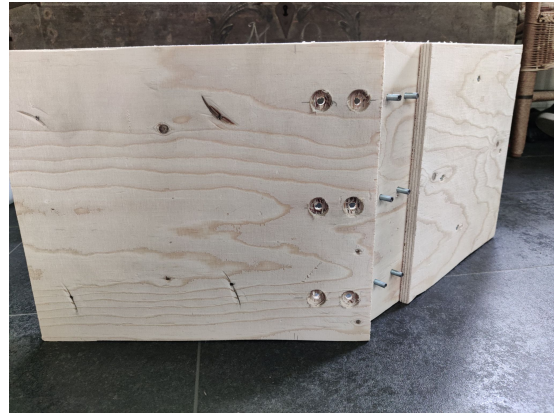
(b) Demontering av halvt om halvt koppling
