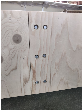
(a) Översikt monterad dubbellask
