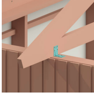
Figur 48: Montage av takstol på hammarband (Lundqvist Trävaru, 2021)
