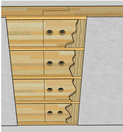
(a) 3D-modellering av halvt om halvt förband
