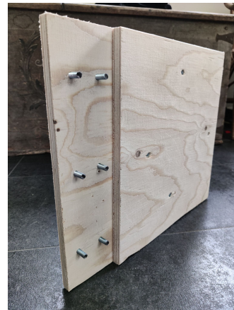
(b) Demonterad halv om halv koppling
