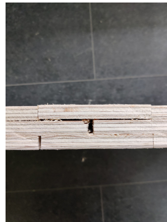
(b) Monterad dubbellask-koppling sedd från ovan
