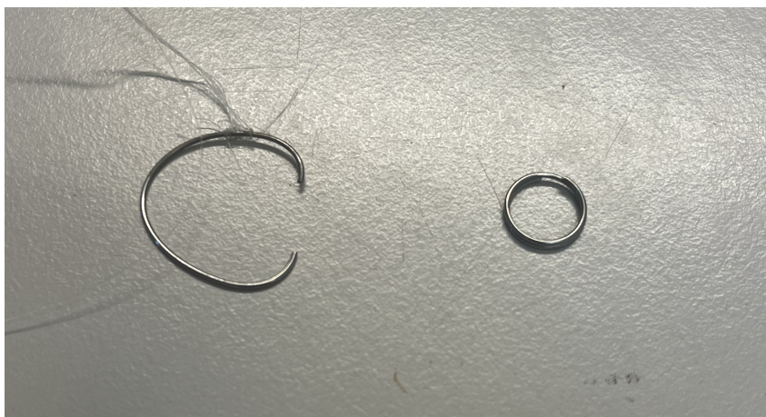
Figur 37: Deformerad nyckelring från fallskärmssystemet efter fälttest nr. 2, jämförd med en ny nyckelring. Deformationen visar att öppningslasten vid den sena fallskärmsutlösningen översteg infästningens hållfasthet.
