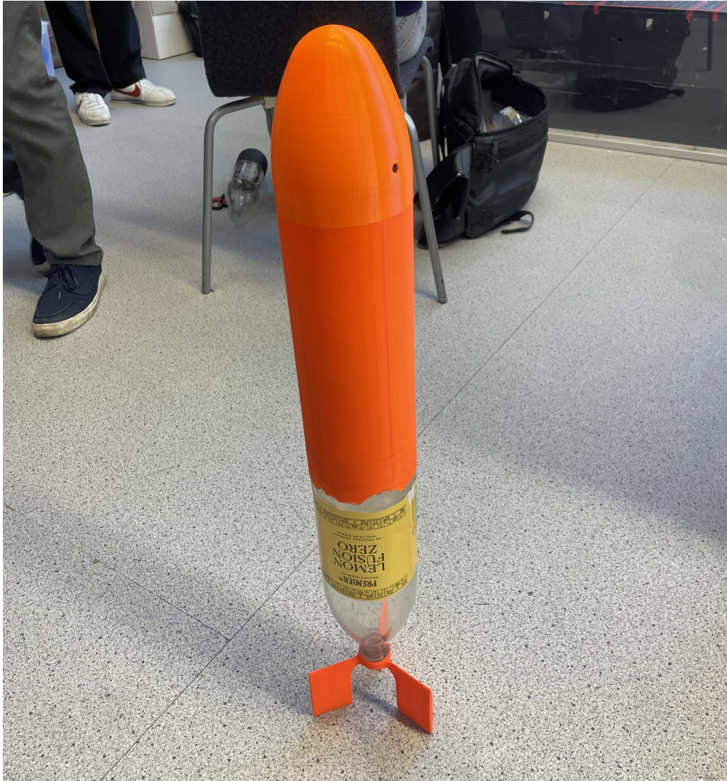
Figur 23: Konstruerad raket med noskon, mittenparti och vingar printad i PETG material
