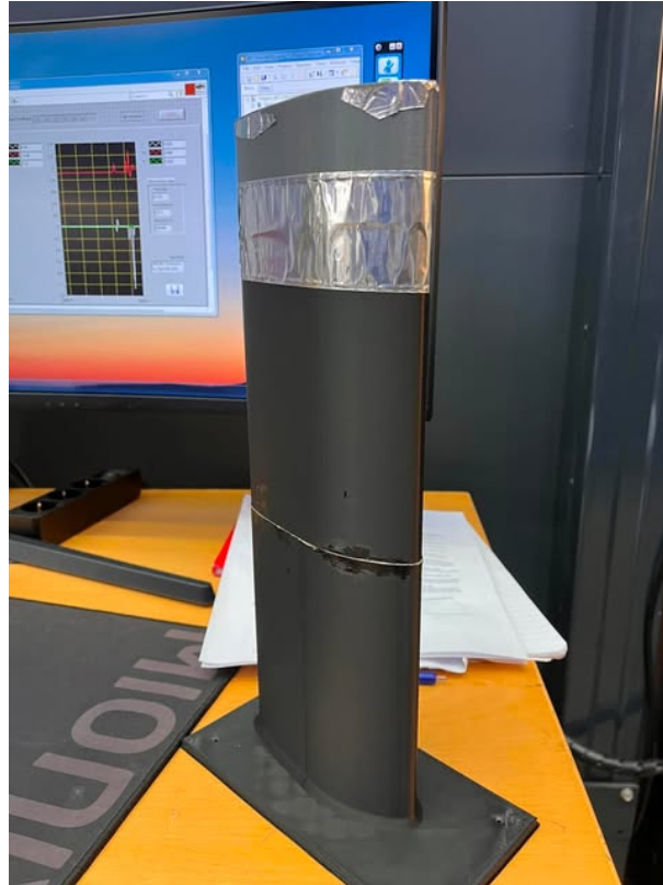
Figur 18: Vindprofil för skydd av mätstativet
