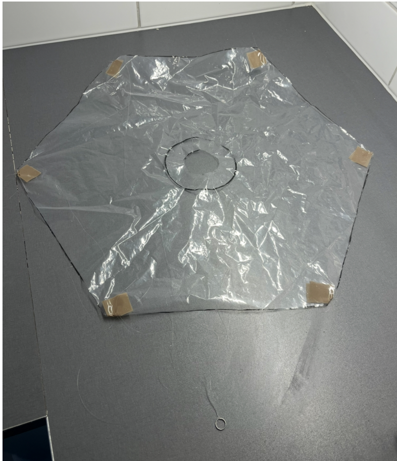
Figur 24: Sexkantig fallskärm tillverkad av PEVA-plast. Linorna fästes i förstärkta hörn och samlades i en nyckelring för enkel montering i raketen.
