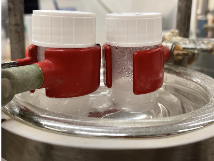
Figur 11: Frysning av CNC-suspensionen med aceton- och kolsyreisbad
