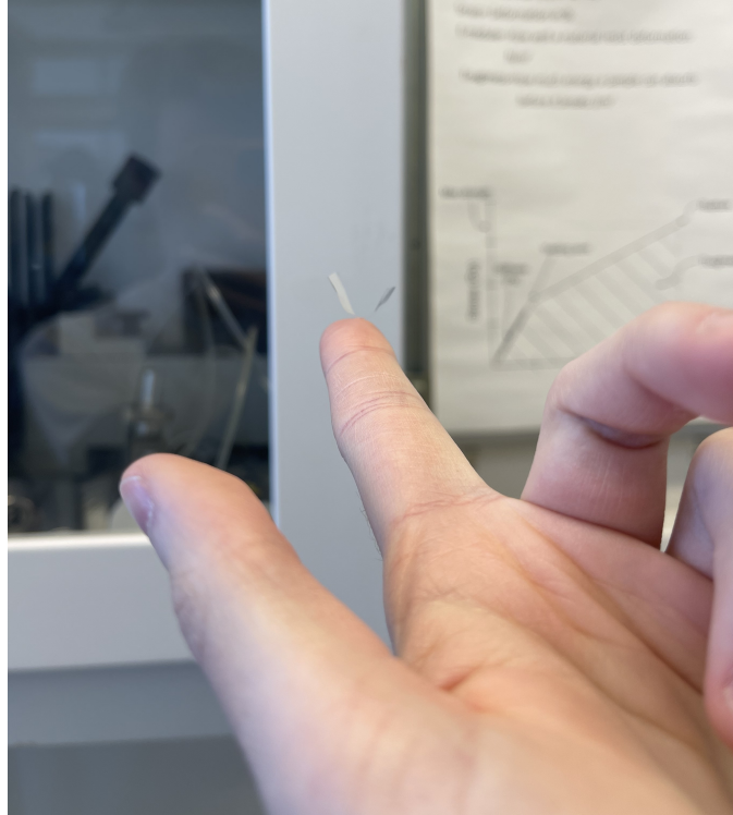
Figur 19: Rektangulär film CNC-film som tydligt krökts vid, under och endast under kontakt med hud. Konkav krökning relativt kontaktpunkten med fingret. Filmen återgår till ursprungsform när hudkontakten avbryts.
