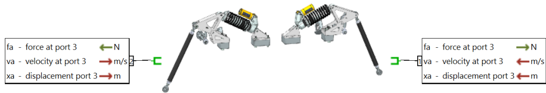
Figur 6.5: In- och utvariabler för fjädringssystemets superkomponent
