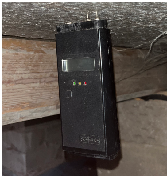
Figur 5.3.2.2 Fuktkvotsmätning i blindbottenskiva med mätinstrumentet Protimeter Digital Mini.
