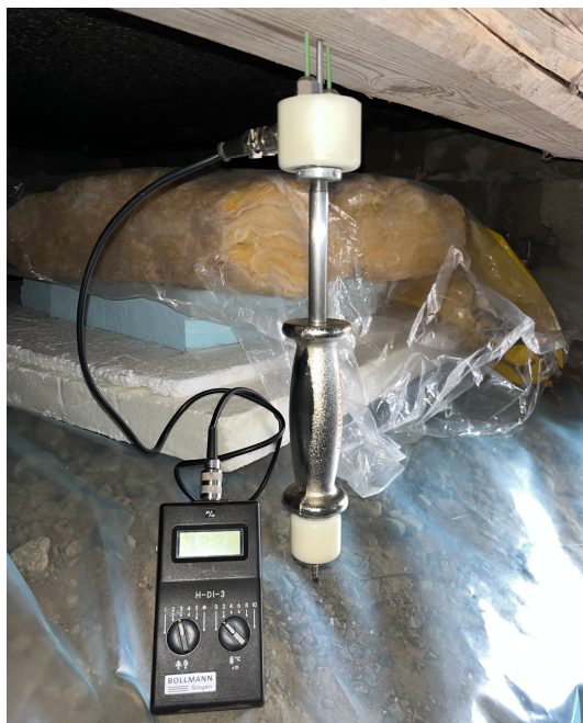
Figur 5.3.2.1 Fuktkvotsmätning i bärlina med mätinstrumentet BES Bollmann Combo 100.
