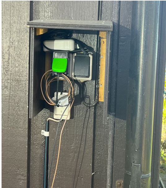
Figur 5.3.3B Placering av mätinstrument Celsicom TH601A för uppmätning av lufttemperatur och relativ luftfuktighet i utomhusluft.
