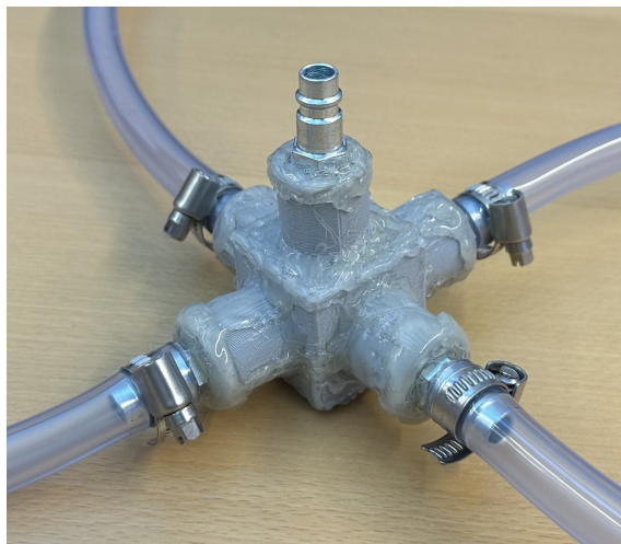
Figur 4.15: Fördelningsenhet för tryckluft med monterade slangkopplingar och anslutna slangar till motorns fyra luftinlopp.
