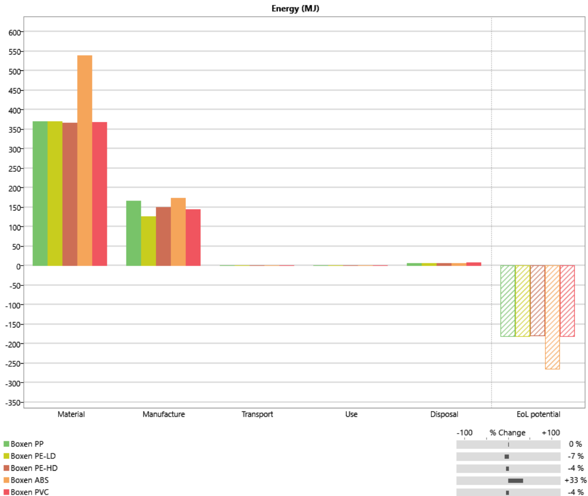
Figur 7. Jämförelse av total energiåtgång för koncept Boxens olika livscyklifaser med olika material. (Granta EduPack, 2023).
