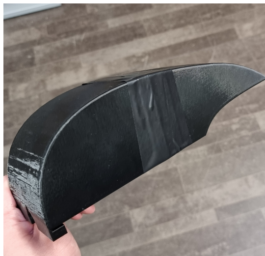
Figur 5.9: Den kompletta framkåpan ihopsatt efter att den skrevs ut i två delar.
