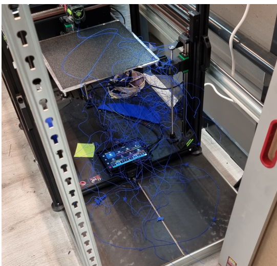
Figur 5.8: 3D-skrivningsfel. Delen rycktes bort på okänt sätt och skrivaren fortsatte sedan att skriva ut filament i luften.
