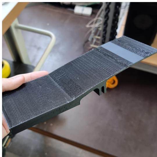
Figur 5.11: Godtagbar utskrift av bakkåpan, grov textur på ytskiktet.
